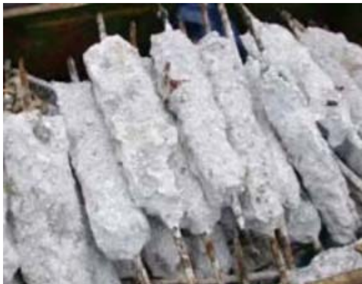
Слика 31. Истрошене аноде [5]
