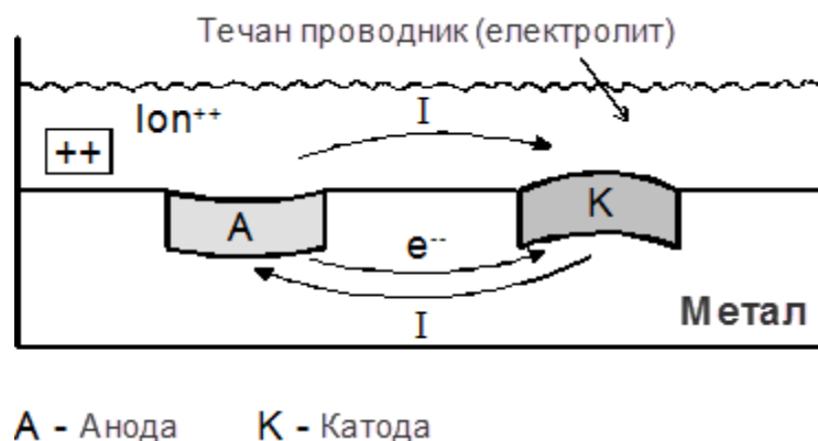
Слика 4. Галвански спрег на истом металу [2]
