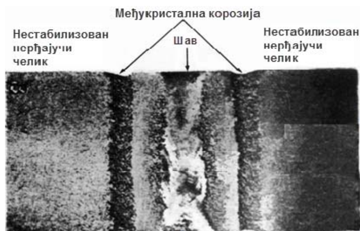
Слика 18. Међукристална корозија завареног нестабилизованог нерђајућег челика у корозионом медијуму [2]
