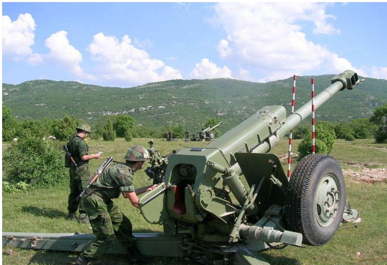
Слика 4. Хаубица 122 мм Д30Ј постављена у борбени положај
