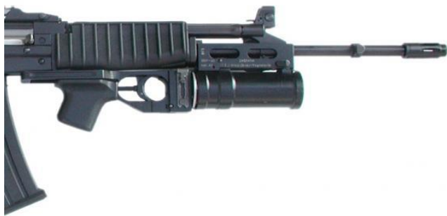
Слика 3. Подцевни бацач граната код АП M21
