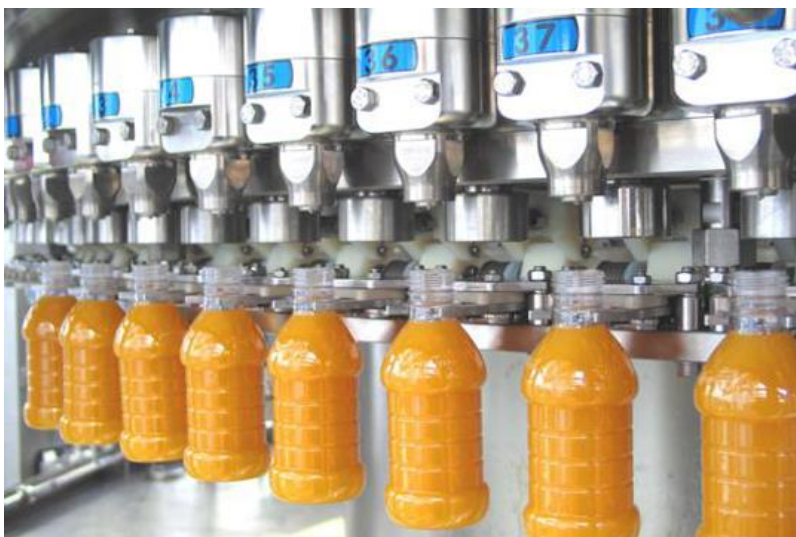
Слика 5. Асептична метода паковања у пластичну амбалажу, [6]
