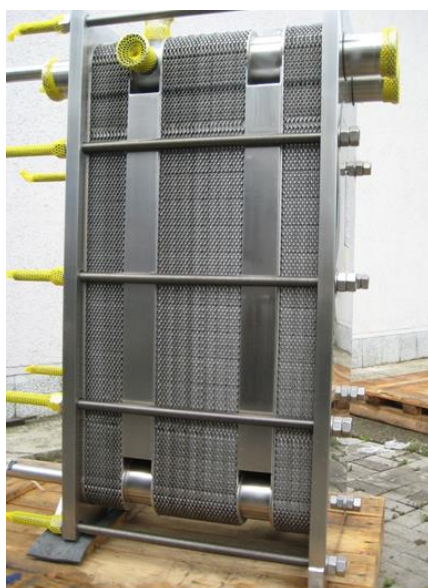
Слика 23. Усвојен плочасти измењивач топлоте
