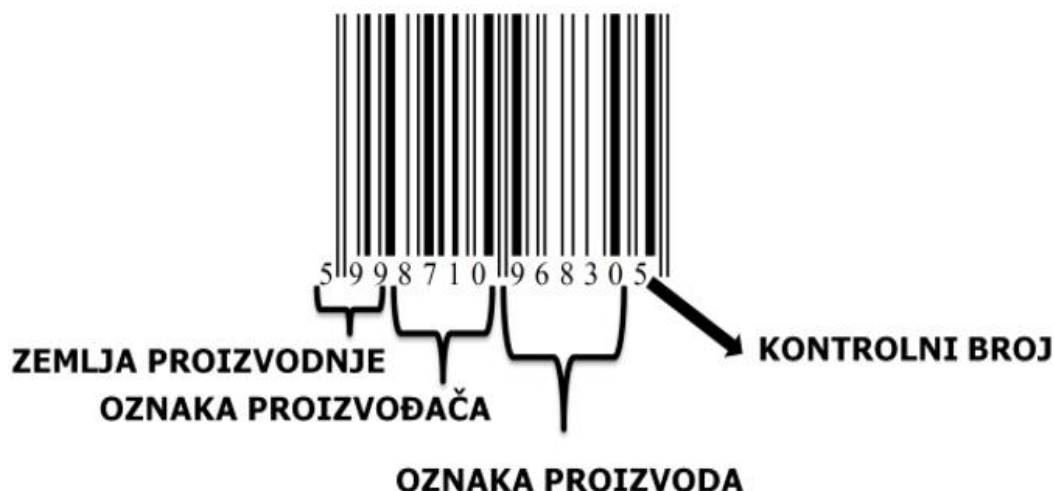
Слика бр. 2 – Структура бар кода
