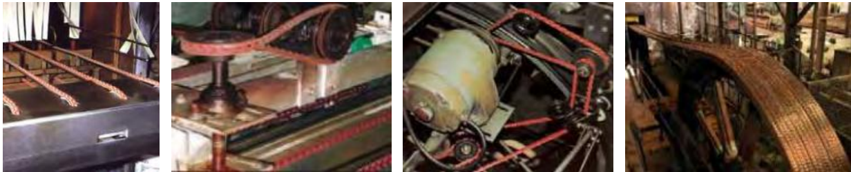
Слика 4.6 – Сегментни каишни преносник у погону, [23, 26, 28]
