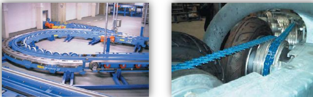
Слика 4.11 – Уградња сегментног каиша у погону за руковање путничким пртљагом, [23, 26]
