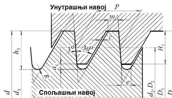
слика бр. 9. – Коси метрички навој
