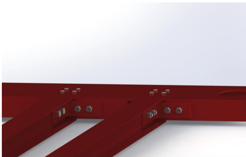
слика бр.19 –Веза носеће чауре са попречним носачем
