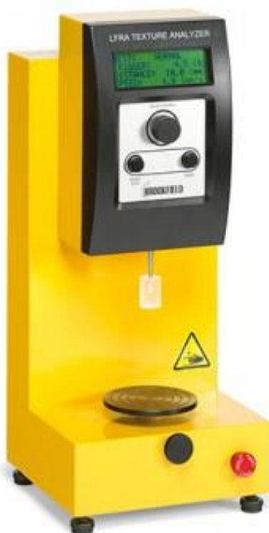
Слика 6.5. Машина на којој су вршена испитивања – “Brookfield CT3 Texture Analyzer”, Факултет инжењерских наука, опрема добијена у оквиру WIMB (543898-TEMPUS-1-2013-1-ES-TEMPUS-JPHES) Tempus пројекта
