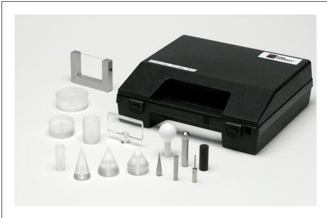
Слика 6.6. Сет индентера различитих облика који се користе при испитивању
