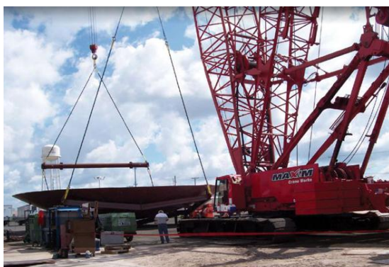
Слика 2.10: Дизалица на гусеницама- Maxime Crane Works [5]
