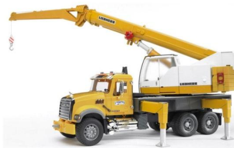
Слика 2.12: Ауто-дизалица са постољем на шасији камиона [7]
