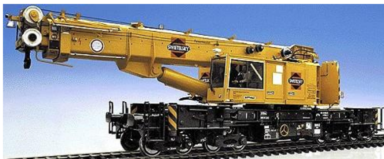
Слика 2.24: Дизалица на шинама [9]
