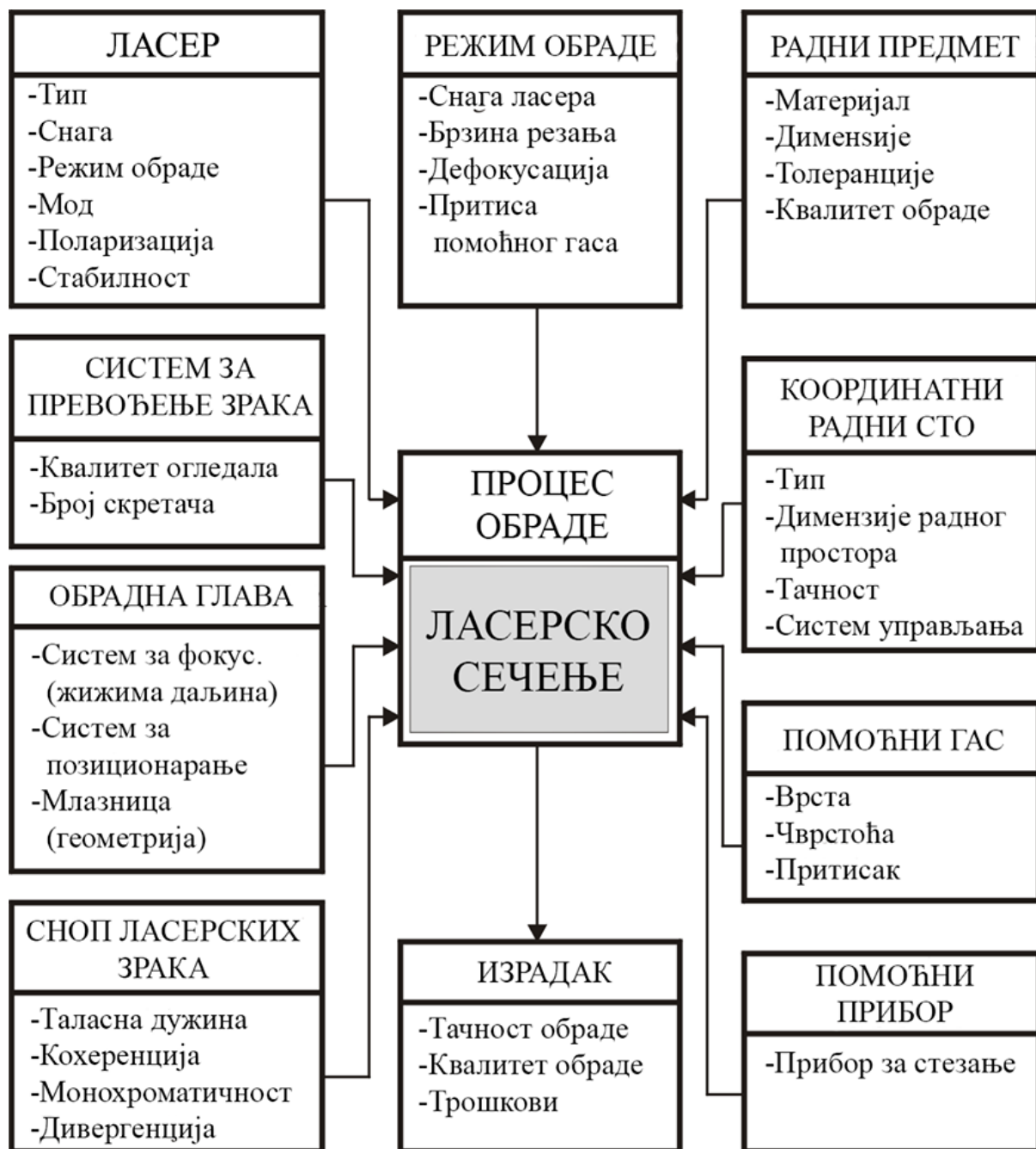
Слика 2.16 Фактори који утичу на процес ласерског сечења [6]
