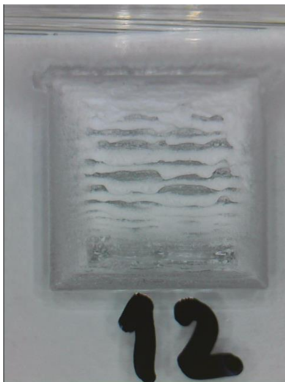
Слика 5.1 Нагомилавање материјала при обради са три пролаза
