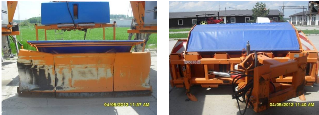
Слика 6.2 Изглед плуга са ножевима који се монтирају на радне машине или возила; а) предња страна; б) задња страна
