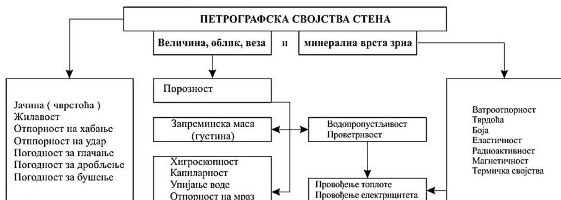
Слика 3.1. Шематски приказ утицаја петрографских својстава на остала својства стена
