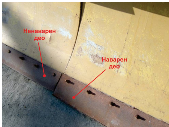
Слика 6.6 Похабаност ненаварених и наварених ножева плуга за чишћење снега: а) похабаност предње стране ножева, б) похабаност задње стране ножева
