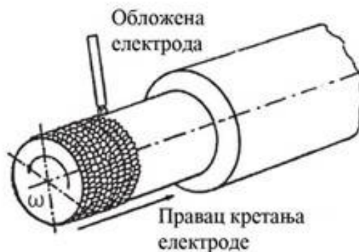
Слика 4.10 Препоручени начин наваривања уз помоћ окретаљки
