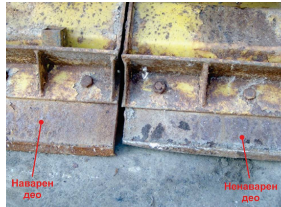
Слика 6.6 Похабаност ненаварених и наварених ножева плуга за чишћење снега: а) похабаност предње стране ножева, б) похабаност задње стране ножева
