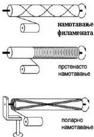
Слика 5.10. Приказ намотавања филамената, прстенастог (ободног) и поларног намотавања
