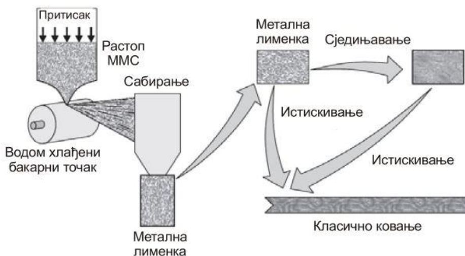
Слика 5.9. Поступак брзог очвршћавања
