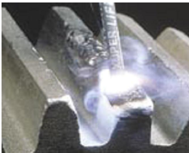
Слика 6.2. Репаратура запремински разорених (поломљених) зуба
