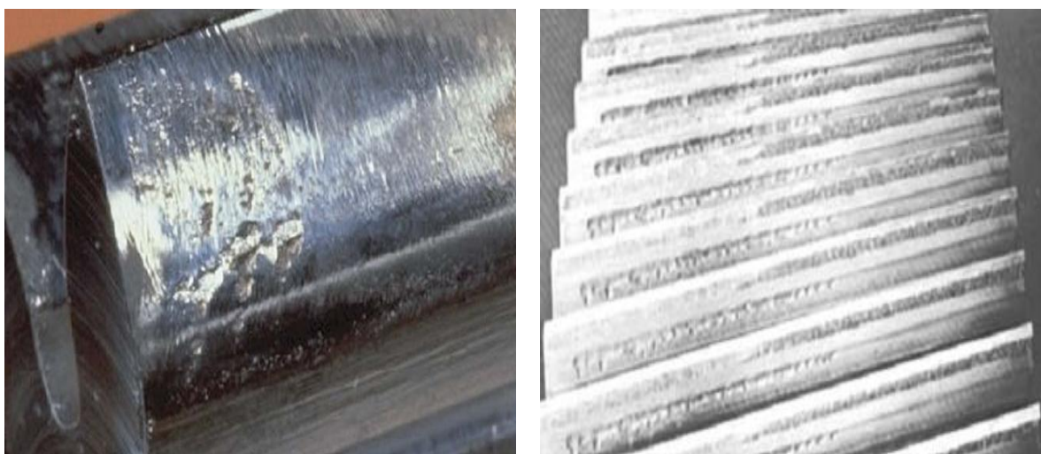
Слика 3.9. Озбиљно оштећење зуба
