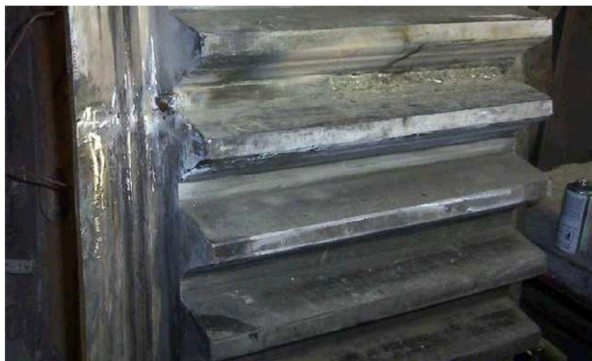
Слика 6.4. Репаратура две прслине код зуба
