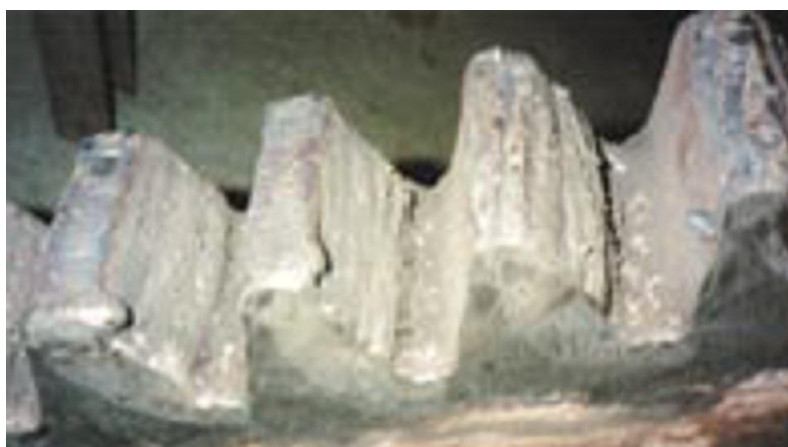
Слика 6.1. Репаратура површински оштећених – похабаних зуба
