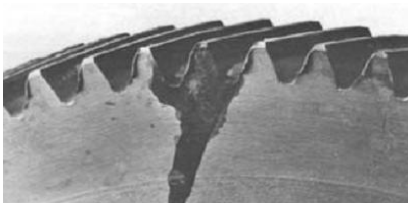
Слика 3.12. Деформација зуба под дејством високих температура
