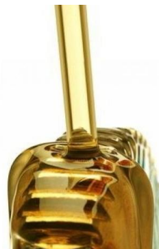
Слика 5.1. Подмазивање зупчаника
