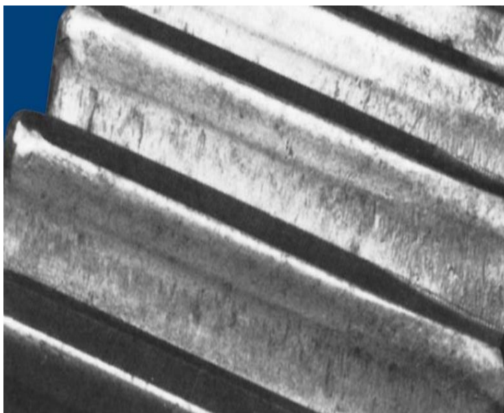
Слика 3.10. Оштећење врха зуба
