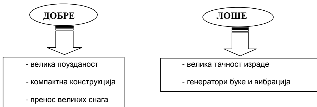
Слика 1.5. Добре и лоше карактеристике зупчастих парова
