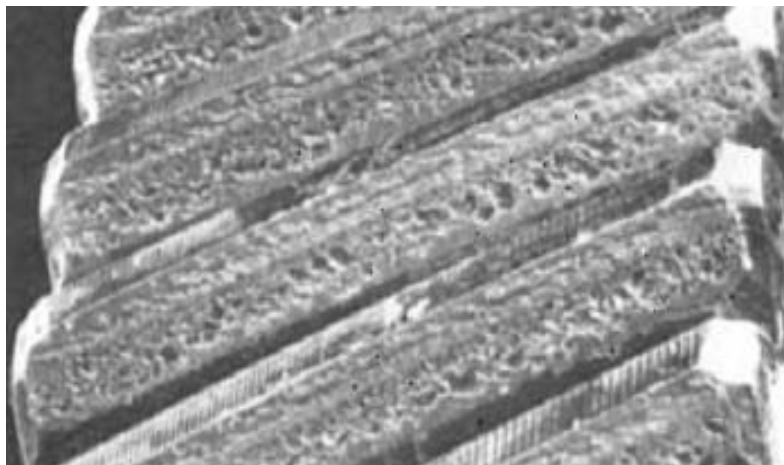
Слика 3.11. Режући скоринг
