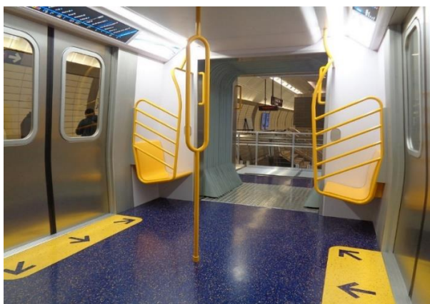
Слика 20. Изглед предложене експерименталне конфигурације за отворени пролаз за метро [69]
