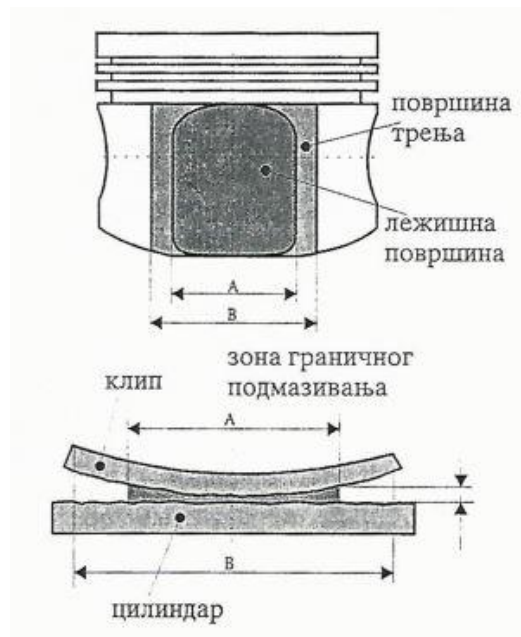
Слика 10. Зона граничног подмазивања између клипа и цилиндра[10]
