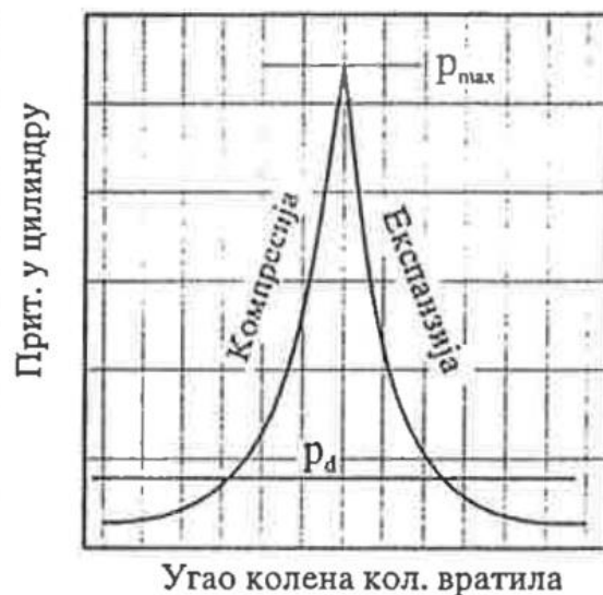
Слика 18. Отворени дијаграм радног процеса без сагоревања [1]
