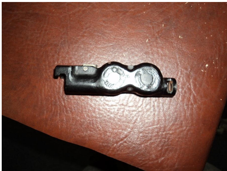
Слика 2.7. Компензатор аутоматске пушке Абакан
