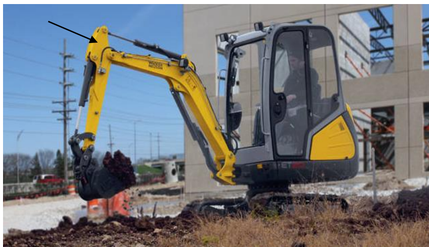
Слика 2. Сегмент руке багера Loeffelstiel 2003 kurz
