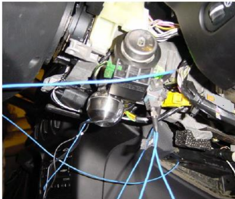
Слика 19 Испитивање система за управљање: побуда минијатурним пулзаторима (лево) и побуда чекићем (десно) [8]
