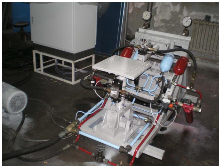
Слика 22 Двоканални хидродинамички пулзатор НР-2007 Факултета инжењерских наука
