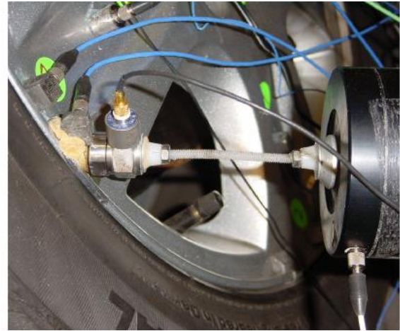
Слика 18 Тест деформације наплатка: побуда помоћу два минијатурна пулзатора (лево) и побуда помоћу класичних пулзатора (десно) [8]
