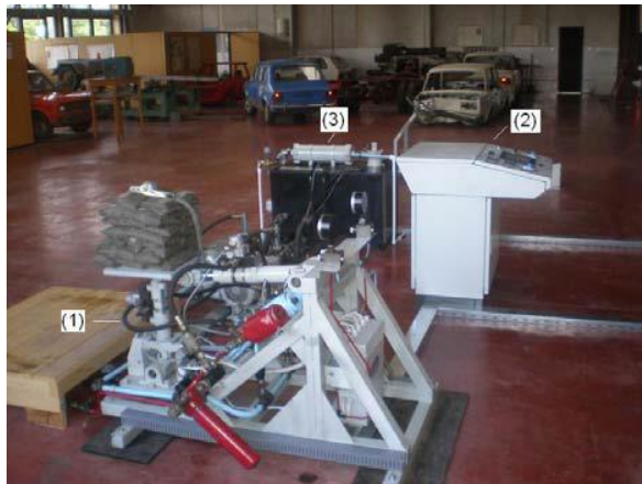
Слика 24 Изглед реализованог лабораторијског пулзатора HP-2007: 1 – хидрауличка платформа, 2 – управљачки пулт, 3 – хидраулички уљни резервоар, 4 – електромотори M1 и M2 пумпног агрегата [9]
