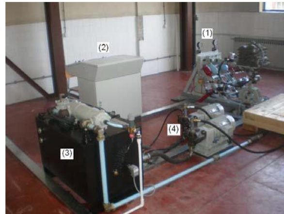
Слика 24 Изглед реализованог лабораторијског пулзатора HP-2007: 1 – хидрауличка платформа, 2 – управљачки пулт, 3 – хидраулички уљни резервоар, 4 – електромотори M1 и M2 пумпног агрегата [9]
