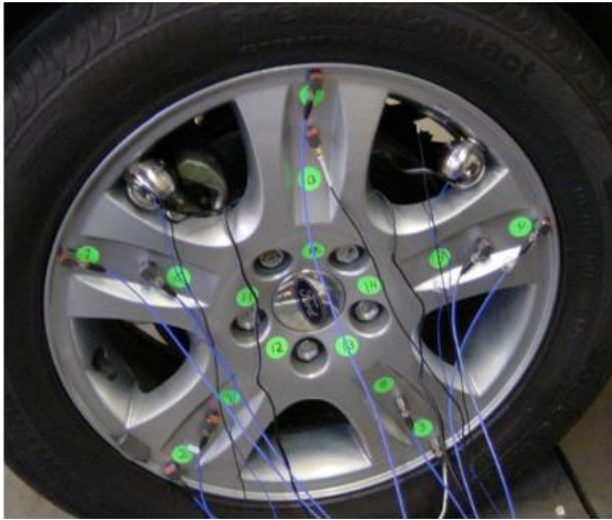
Слика 18 Тест деформације наплатка: побуда помоћу два минијатурна пулзатора (лево) и побуда помоћу класичних пулзатора (десно) [8]
