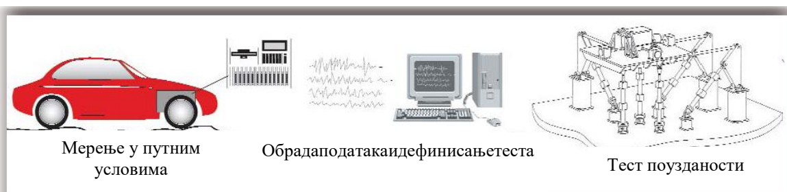
Слика 5 Повезаност путних и лабораторијских испитивања осцилаторних процеса возила[1]
