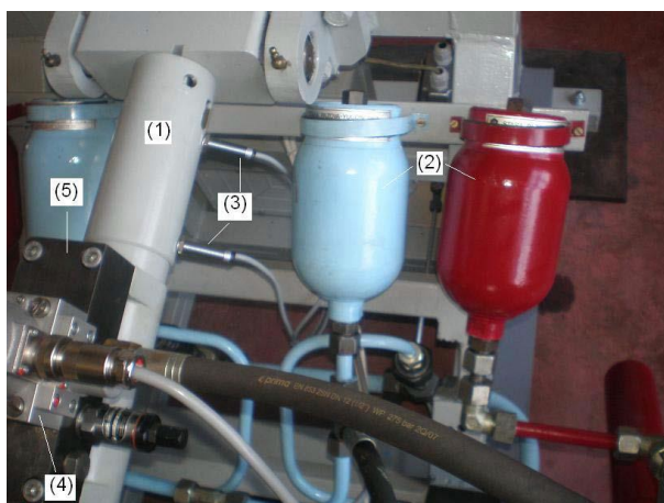
Слика 29 Детаљ серво-хидрауличког појачивача по Х-оси: 1 – серво-хидраулички цилиндар, 2 – акумулатори, 3 – индуктивни сензори крајњих положаја цилиндра, 4 – серво-вентил, 5 – серво-разводна плоча [9]
