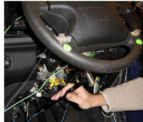
Слика 19 Испитивање система за управљање: побуда минијатурним пулзаторима (лево) и побуда чекићем (десно) [8]
