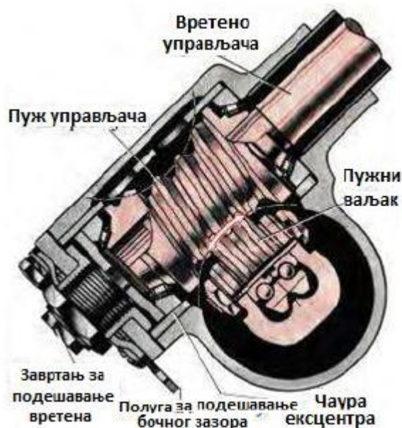
Слика 4.23: Управљачки преносник са пужним ваљком[3]
