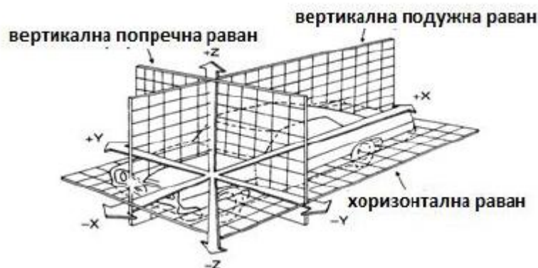
Слика 5.1: Тростандимензионални координатни систем за мерење видног поља[3]
