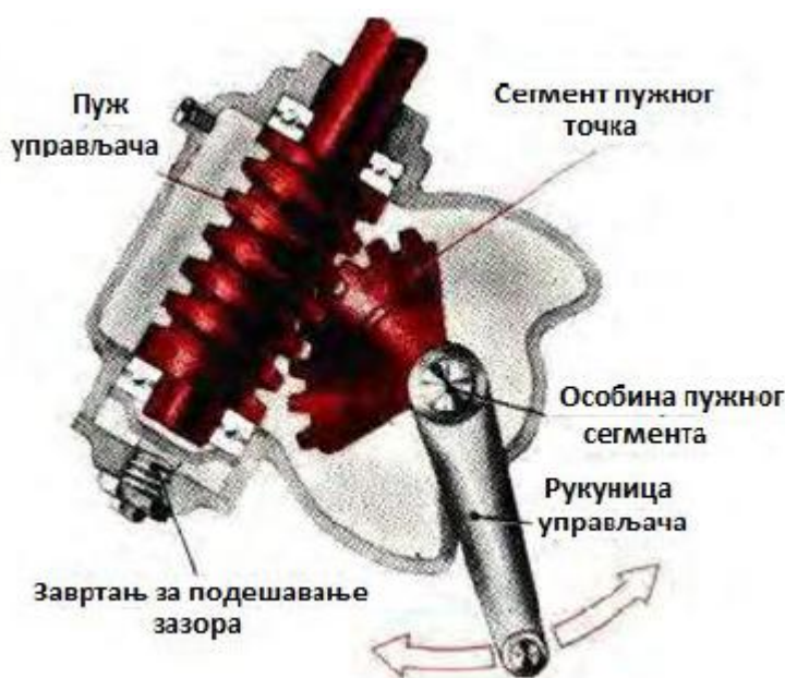
Слика 4.22: Управљачки преносник са пужним елементима[3]
