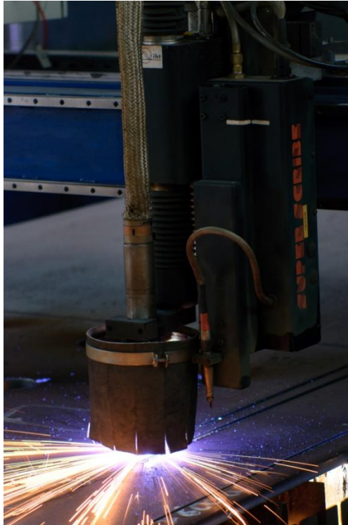
Слика 2- Неконвенционални поступак обраде сечење плазмом
