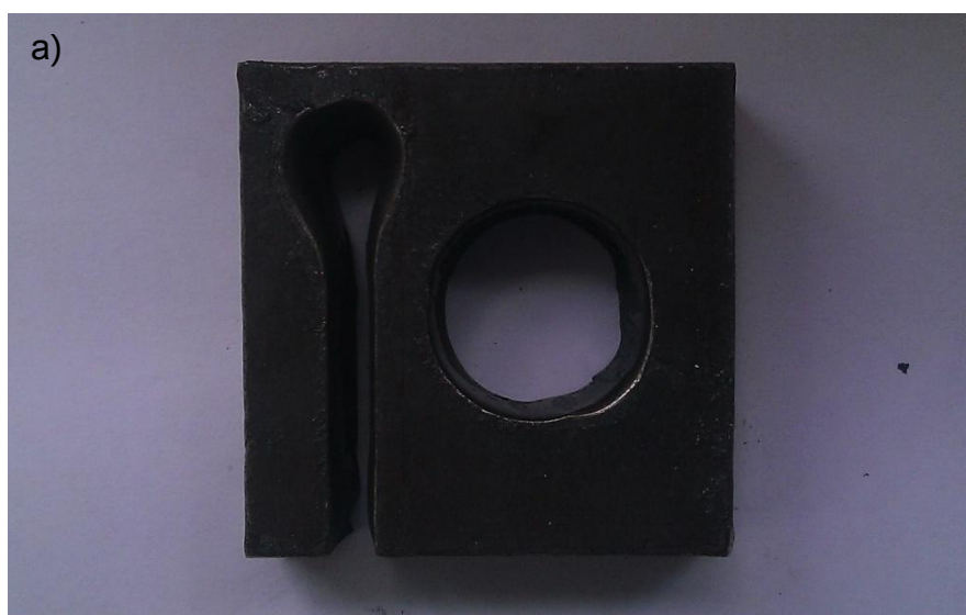
Слика 89- Узорак 17-2600 mm/min а)поглед одозго б)поглед с'преда
