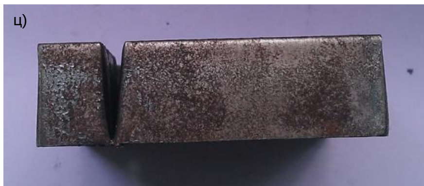
Слика 85- Узорак 13- Дизна II нивоа похабаности а) поглед одозго б) одоздо б) с'преда
