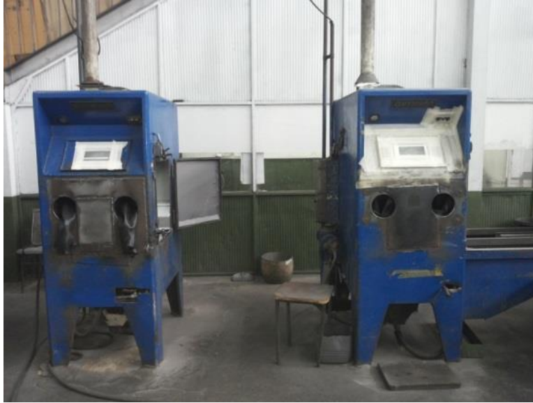
Слика 7.1. Ручна машина за пескарење [4]
