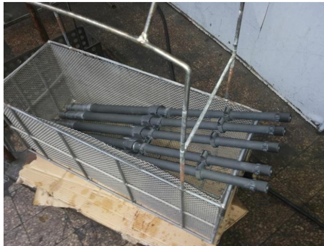
Слика 7.4. Метална корпа са деловима за фосфатирање [4]
