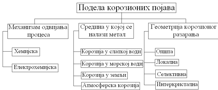
Слика 2.1. Подела корозионих појава [1]
