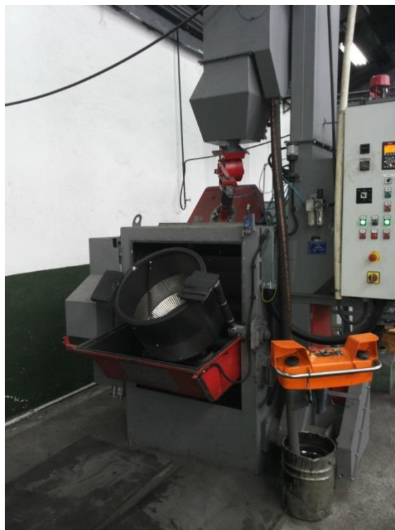
Слика 7.2. Машина за пескарење са бубњем [4]
