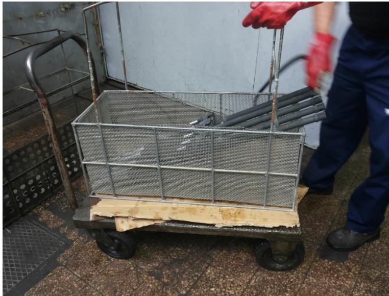
Слика 7.14. Сушење делова компримованим ваздухом [4]
