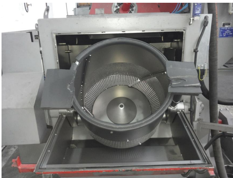
Слика 7.3. Бубањ за пескарење [4]
