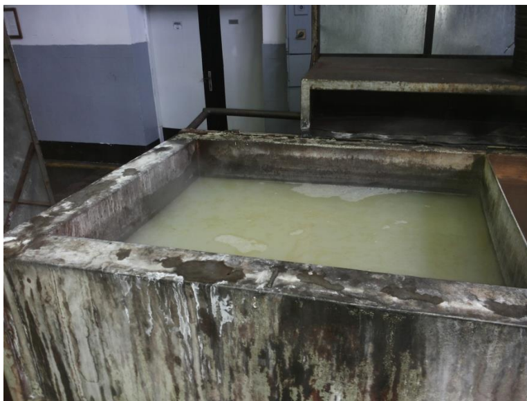
Слика 7.6. Када за одмашћивање [4]
