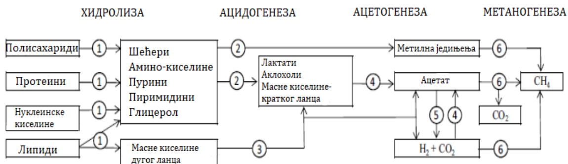
Слика 12. Фазе анаеробне дигестије органске материје: 1) хидролиза биополимера, 2) ацидогенеза, 3) \beta -оксидација масних киселина дугог ланца, 4) ацетогенеза, 5) оксидација ацетатом, 6) метаногенеза
