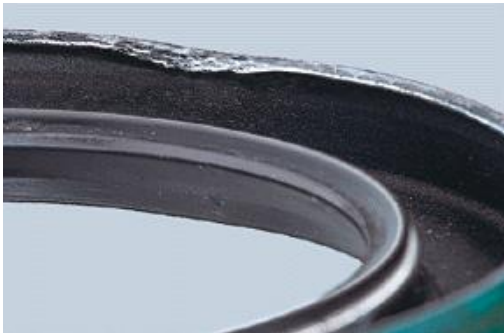
Слика 22. Пример оштећења заптивке услед монтаже (превлачења) преко навоја, [3]
