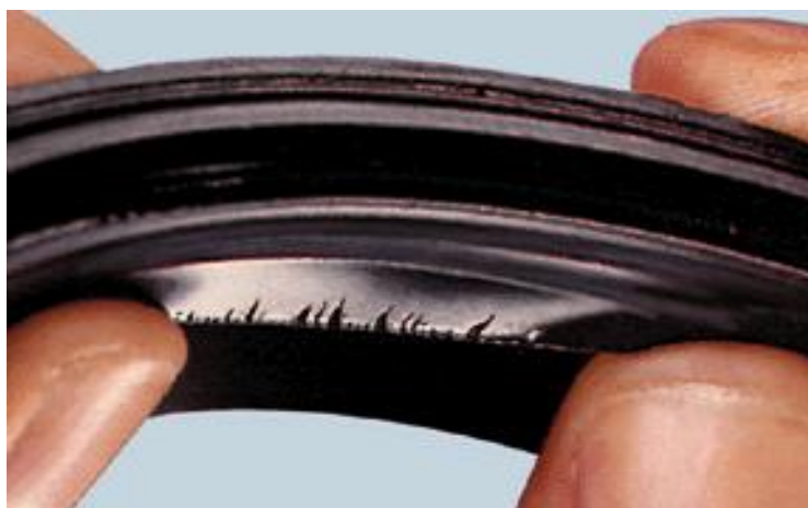
Слика 23: Карактеристичан изглед оштећене заптивке услед недостатка средства за подмазивање, [3]
