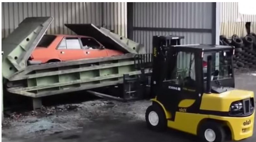
Слика 2 - Приказ хидрауличне пресе за балирање шкољки ОВ
