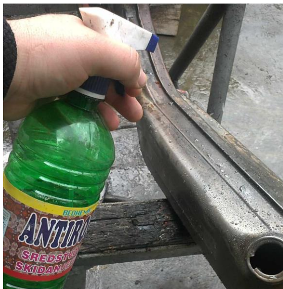
Слика 4.7 Наношење антикорозивне течности на површину метала
