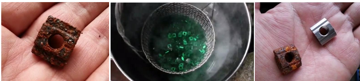
Слика 6.1 Процес никловања елемента у топлом раствору никл сулфата
