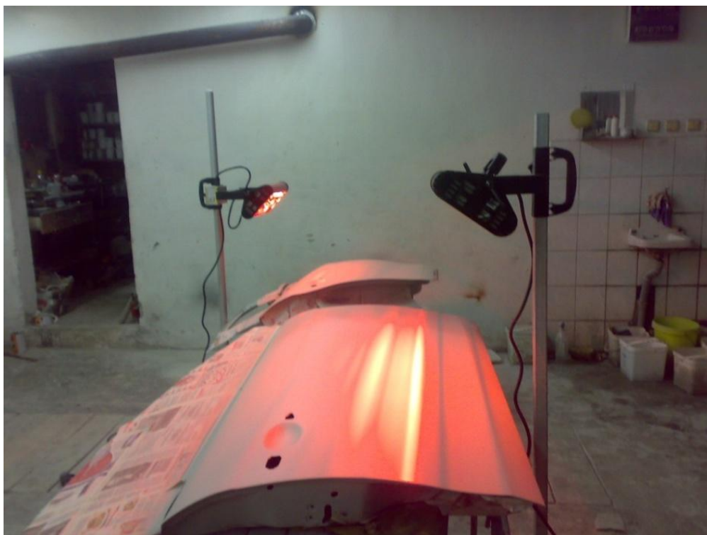
Слика 4.9 Сушење инфрацрвеним лампама течног гита нанесеног пиштољем
