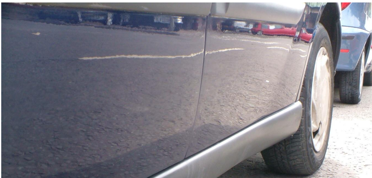
Слика 8.2 Оштећење површине аутомобила узроковано оштрим предметом
