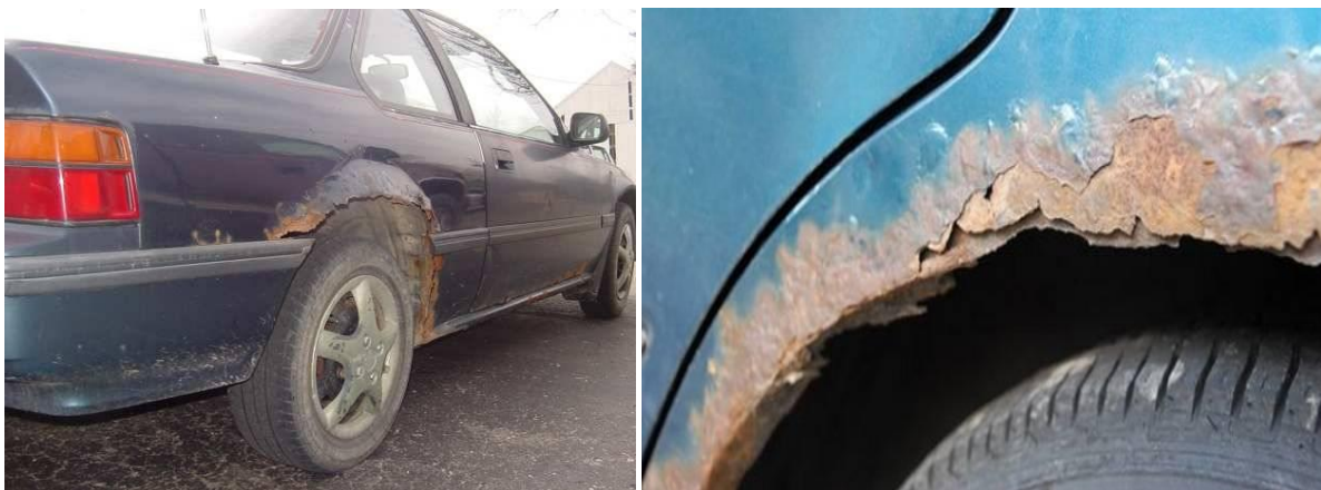
Слика 4.3 Делови захваћени корозијом у каснијем периоду
