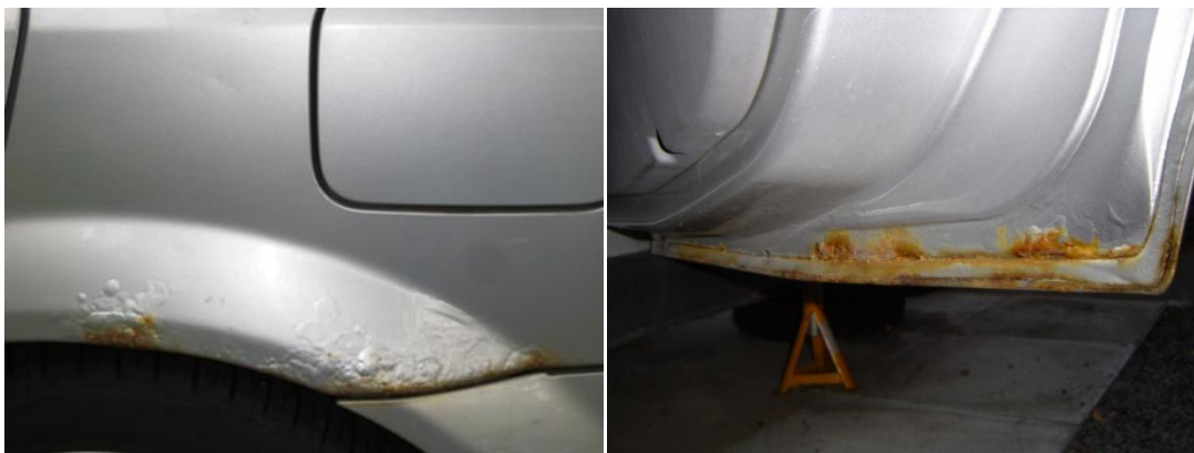
Слика 4.2 Најчешћи облик корозије каросерије аутомобила
