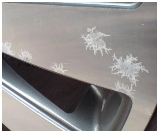
Слика 2.4 Нитаста корозија на површини наплатке аутомобила
