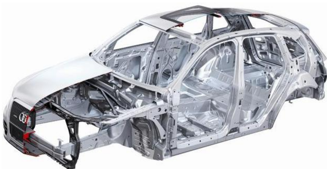
Слика 4.1 Пресек каросерије у изометрији
