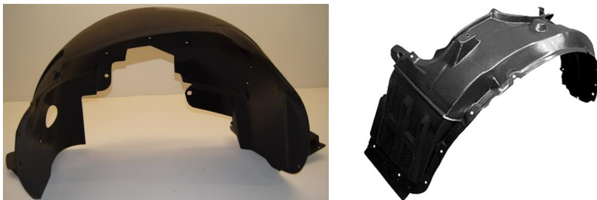
Слика 3.1 Пластични делови који се уграђују иза точкова и који обезбеђују заштиту од продора воде или блата
