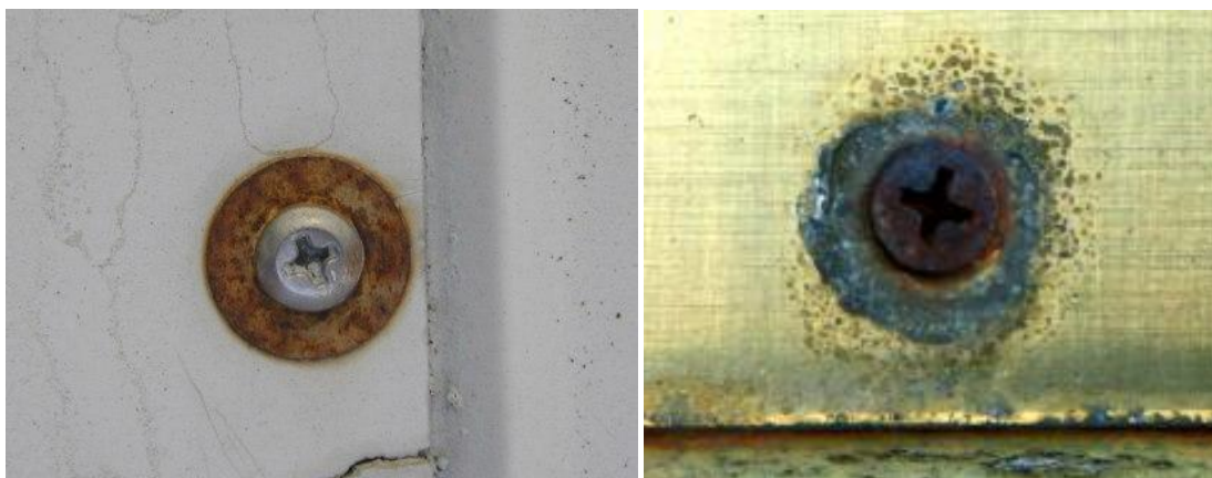
Слика 2.5 Пример галванске корозије на спојевима оствареним завртњевима
