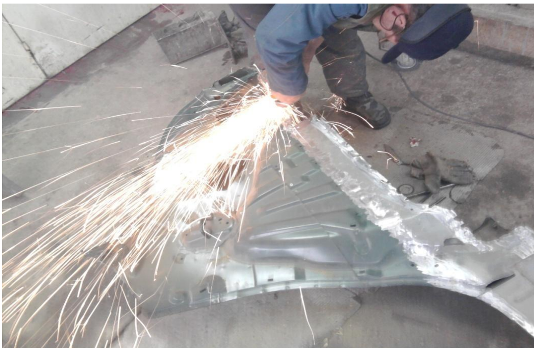
Слика 4.5 Брушење је један од најбољих начина скидања корозије са места на деловима аутомобила
