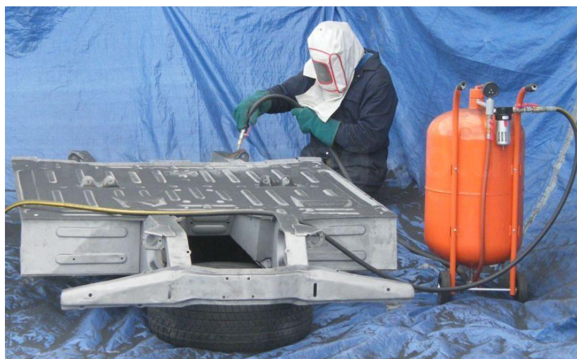
Слика 4.6 Пескарење подног дела комбинованог возила
