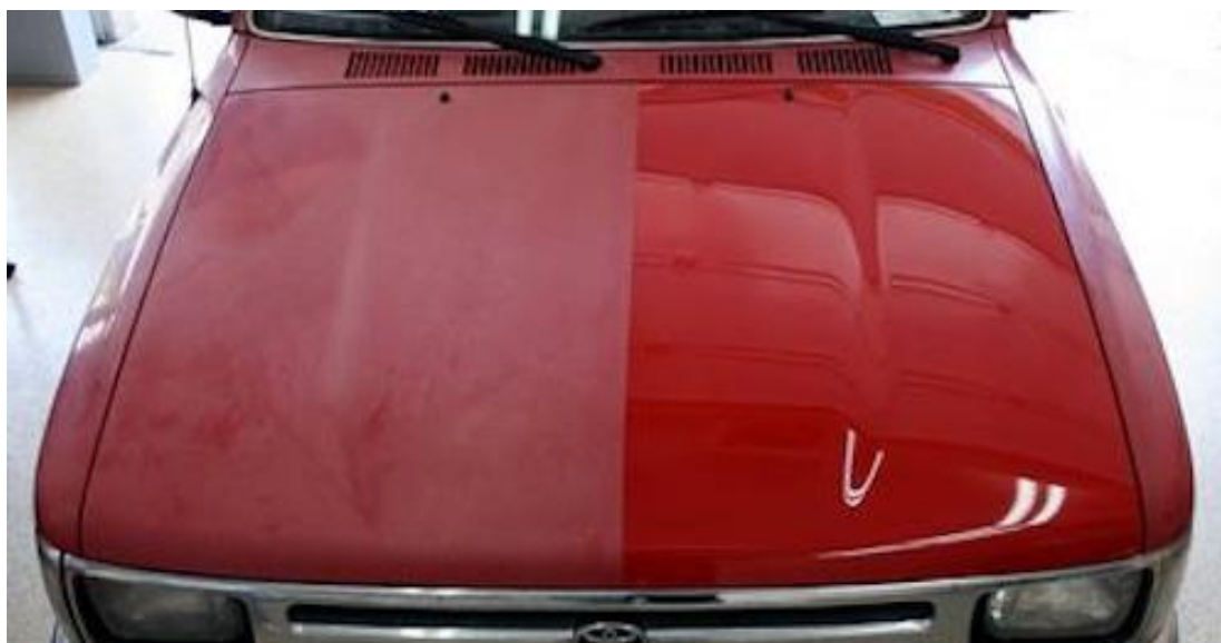
Слика 8.4 Површина пре и после полирања
