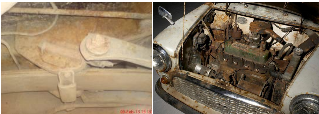
Слика 4.4 Делови аутомобила подложни корозији са мањом приступачношћу за заштиту у односу на спољашње површине
