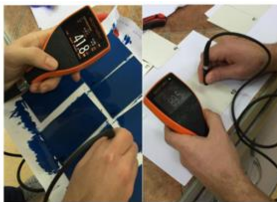
Слика 17. Мерење дебљине превлаке [14]
