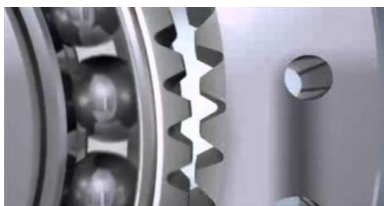
Слика 3.5 Зазор између еластичног и чврстог зупчаника
