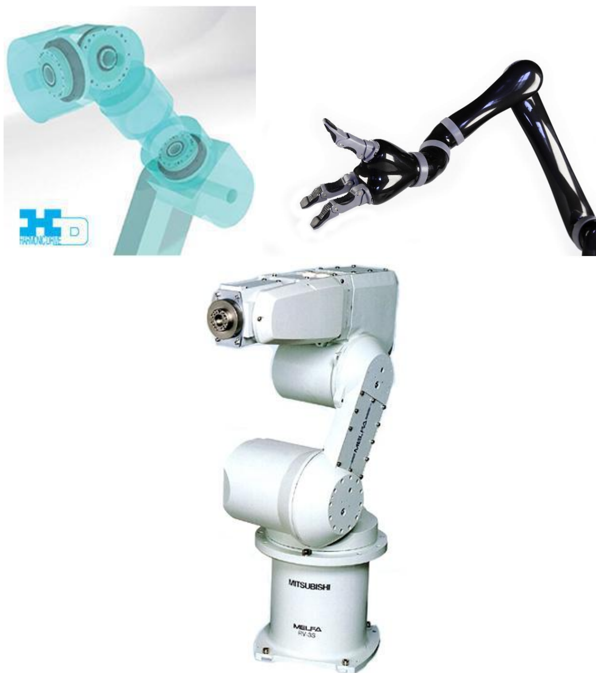
Слика 3.9 Примена таласних редуктора у роботизици
