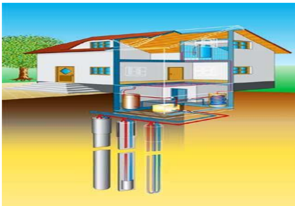
Слика 18. Систем топлотне пумпе са топлотним сондама [9]
