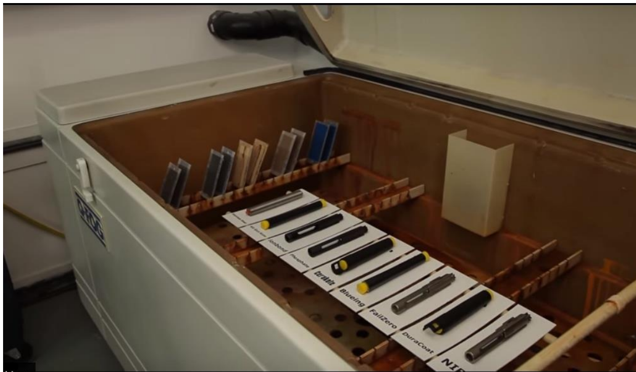
Слика 16 – Унутрашњост слане коморе са узорцима за тестирање [13]
