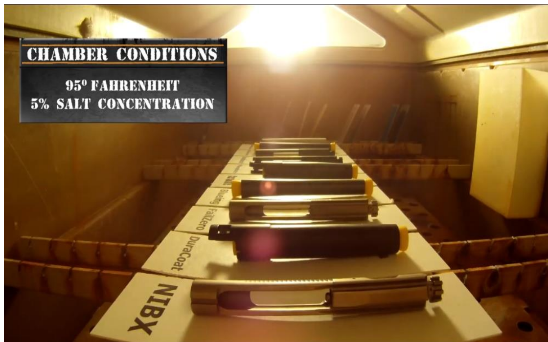
Слика 13 – Подешавање температуре и концентрације соли у сланој комори [13]
