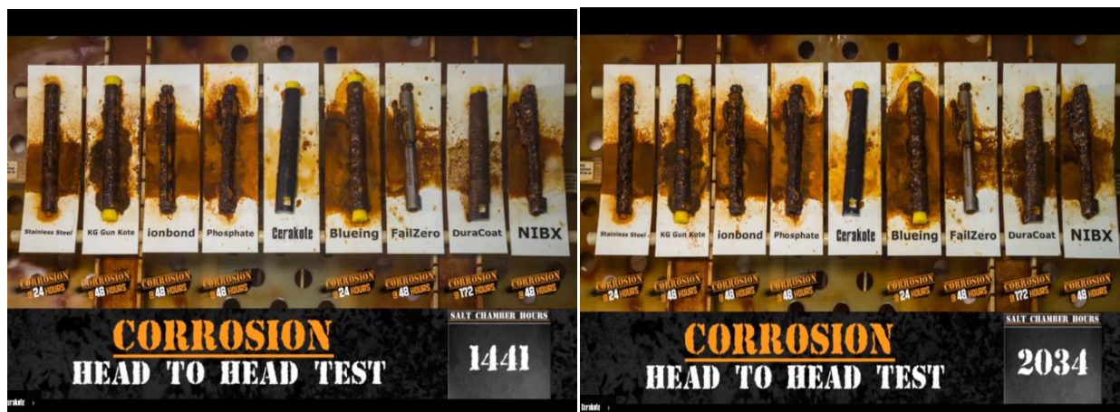
Слика 19 – Упоредивање степена корозије на узорцима након 1441 сати и након 2034 сати тестирања у сланој комори
