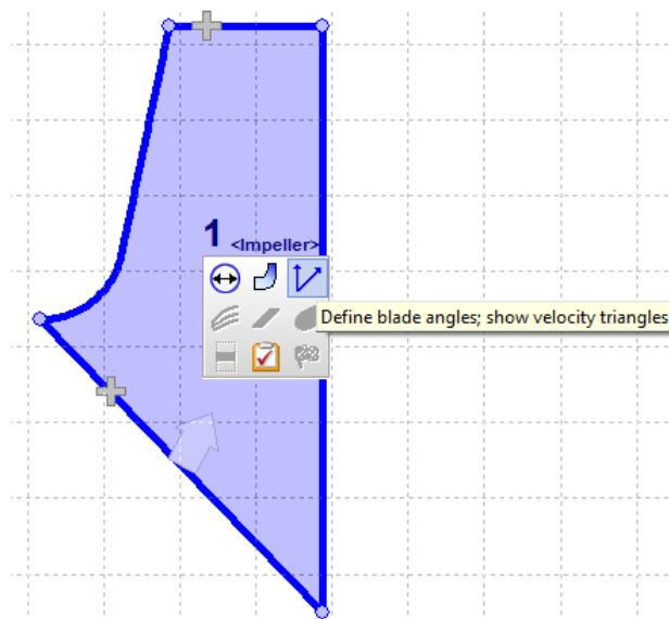
Слика 4.13 Опција за подешавање улазних и излазних углова
