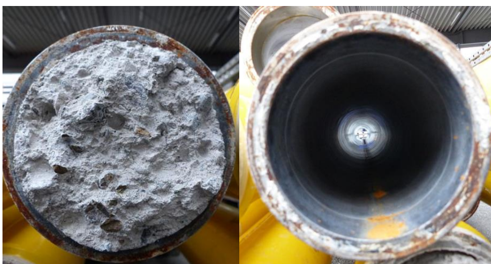
Слика 35. Резултат чишћења цеви: слика лево пре, слика десно после чишћења [47]
