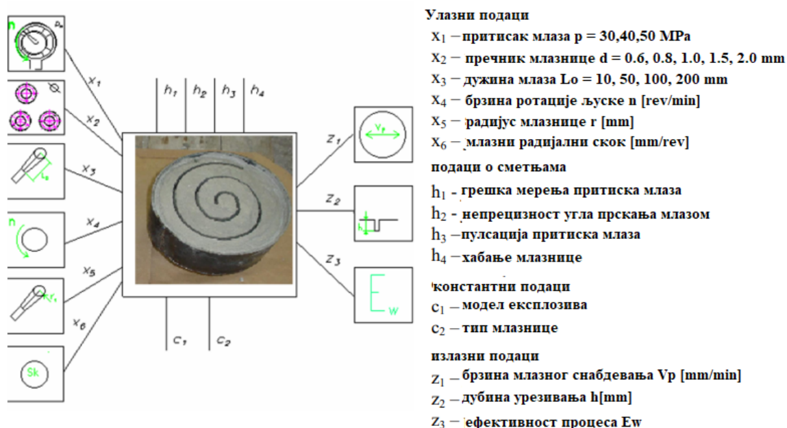
Слика 13. Општа шема испитиваног предмета [56]
