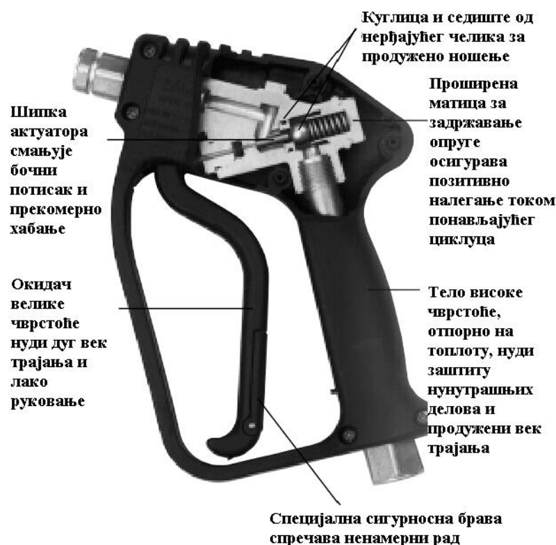
Слика 49. Полупресек млазног пиштоља [53]
