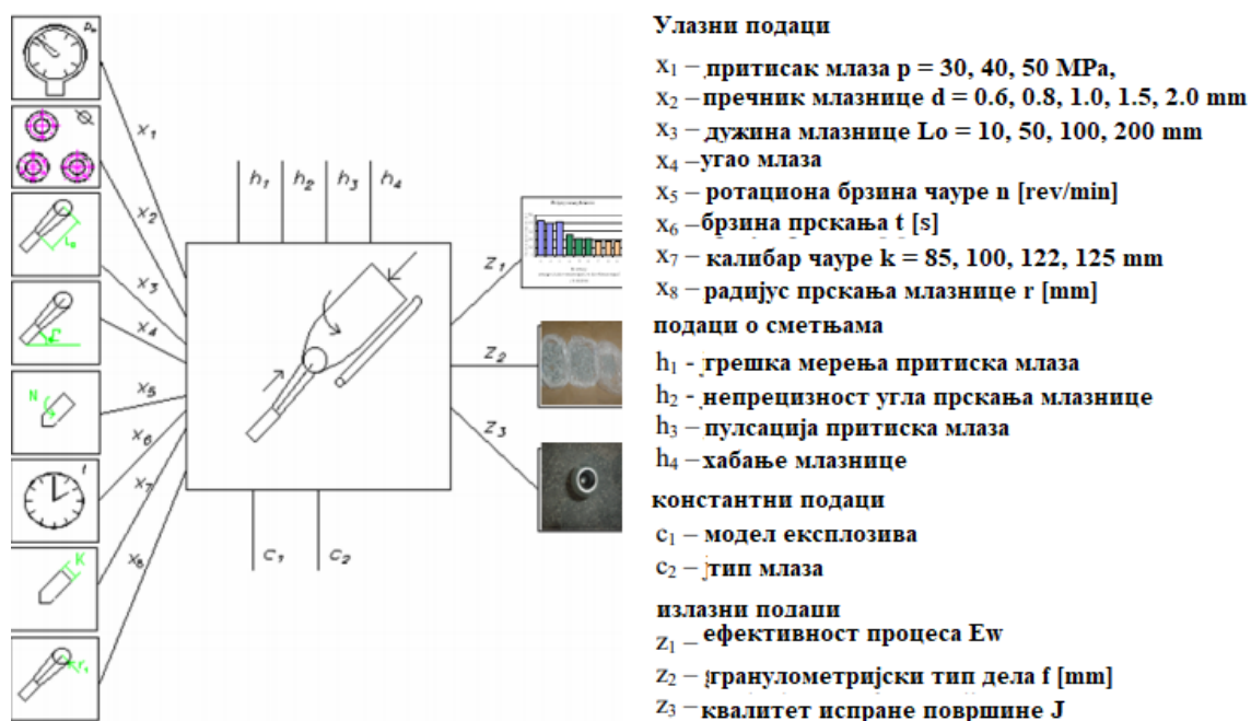
Слика 14. Општа шема испитиваног предмета са дефинисаном ефикасношћу ерозије [56]
