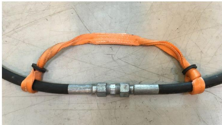
Слика 22. Механизам за ограничење кретања црева [39]
