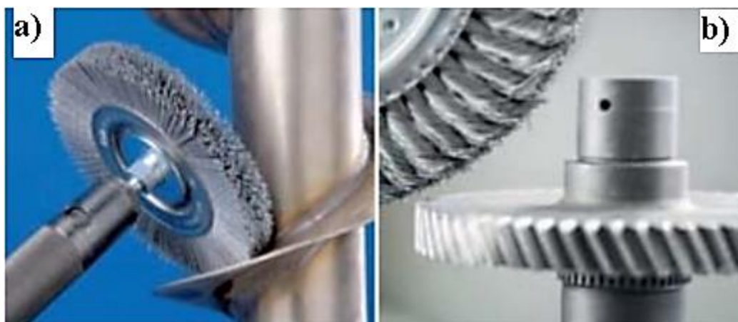
Слика 5. Пример примене алата са челичним влакнима: а) обрада завареног споја, б) равнање храпаве ивице зупчаника [23]
