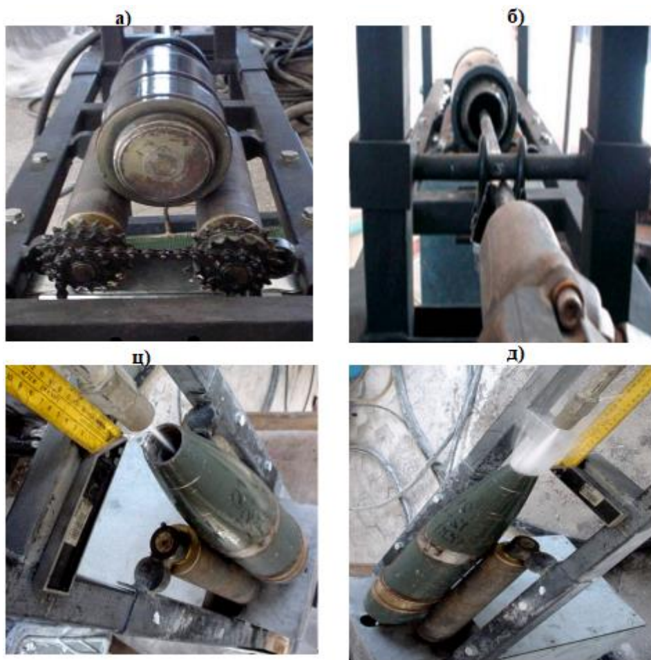
Слика 11. Експериментално постоље: а) погон муниције, б) систем високог притиска, ц, д) различите фаце процеса испирања експлозива [56]
