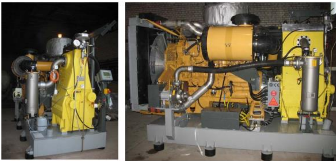
Слика 12. Hattemann HDP 483 систем пумпи ( p_{\text{max}} = 150 \text{ МПа} , Q_{\text{max}} = 2.6 \text{ dm}^3 \text{ s}^{-1} ) [56]
