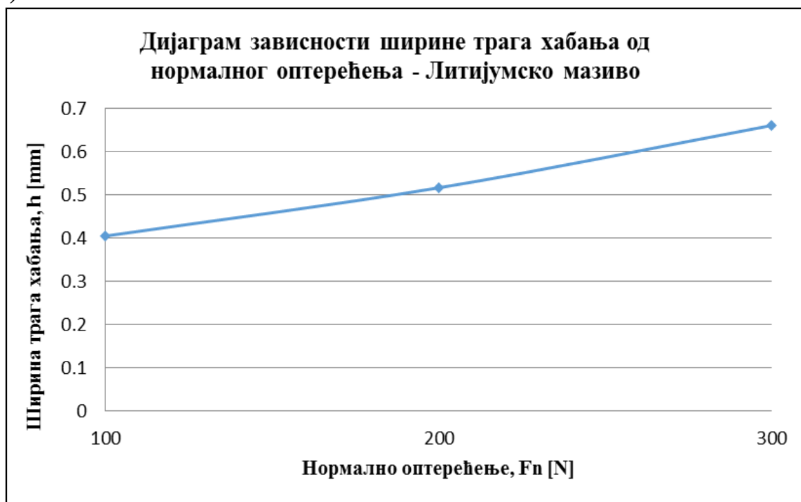
Дијаграм 6. Зависност ширине трага хабања од нормалног оптерећења
