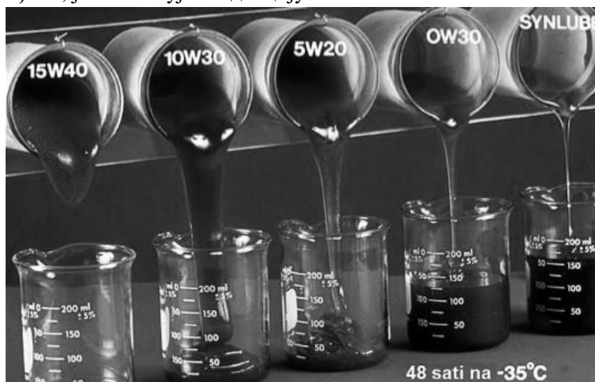
Слика 13. Приказ разлике вискозности истицањем 200ml различитих уља након 2 дана на -35^{\circ}\text{C} [3]
