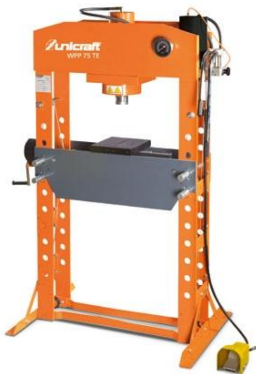
Слика 21. Хидраулична преса произвођача „UNICRAFT” до 75 тона [11]
