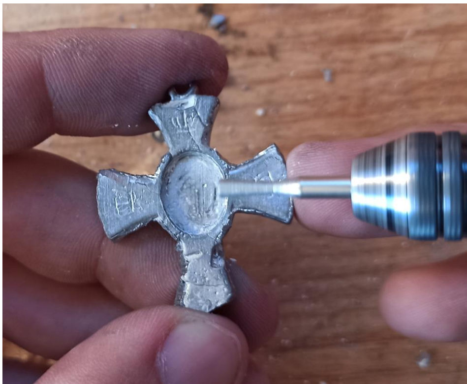
Слика 73. Брушење дефеката насталих приликом изливања и остатака материјала који нису могли бити отклоњени у претходном кораку употребом дијамантских глодала
