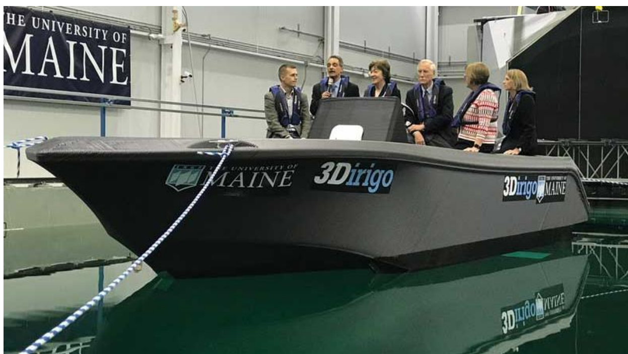
Слика 27. Графички приказ највећег модела произведеног 3Д штампом, чамац 3Дирого произведен на Универзитету у Мејну [26]
