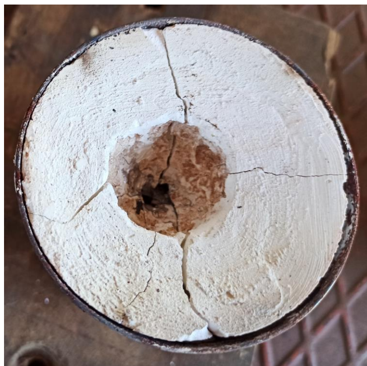
Слика 70. Калуп након уливања метала, метал није попунио све шупљине модела, већ је расут на пукотине унутар калупа, те нема преливања на врху
