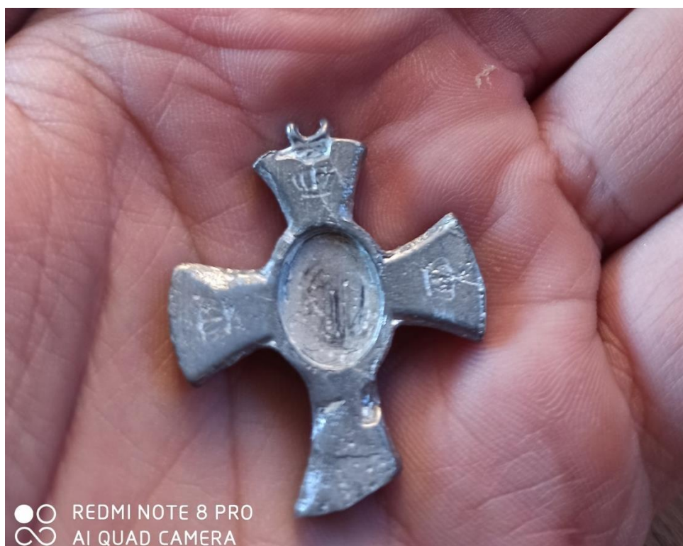
Слика 74. Одливак брушен брусним папиром до гранулације Р600
