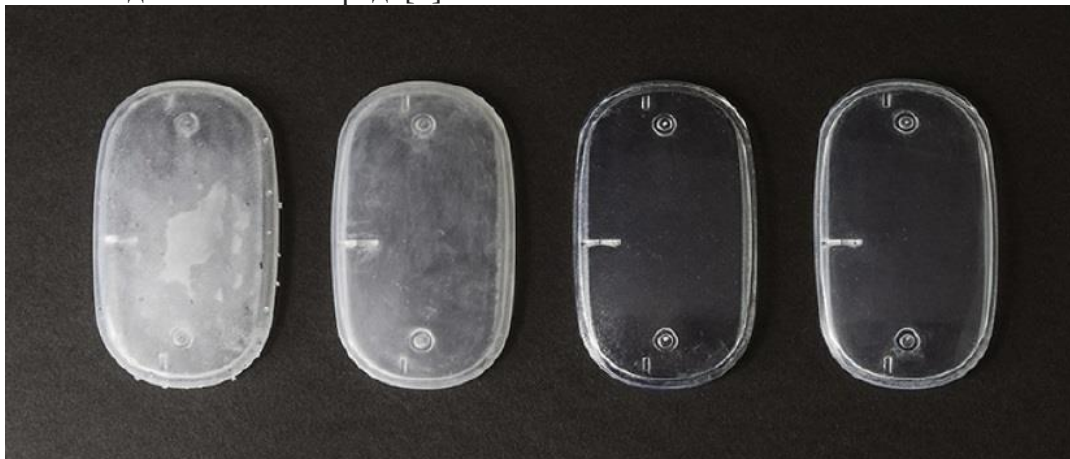
Слика 9. Приказ транспарентног резина у различитим фазама пост процесирања. Са лева на десно: отклањање потпорних материјала, мокро шмирглање, наношење UV резистентног акрилног лака и полирање.[1]
