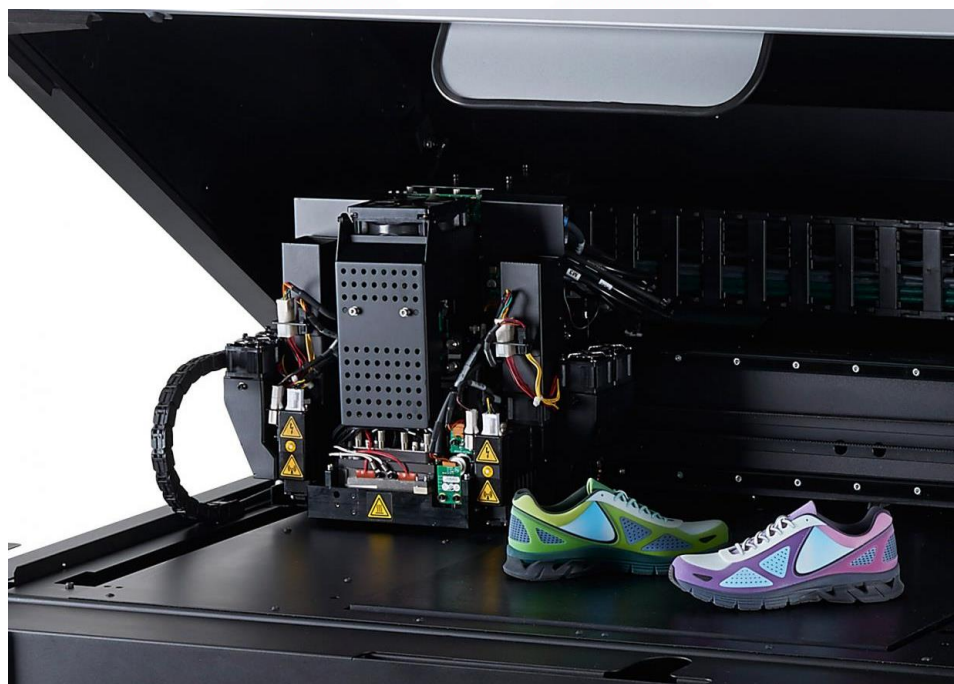
Слика 16. Шематски приказ Material Jetting методе штампе (горе) [14] и пример Material Jetting штампача са штампаним моделима (доле) [15]
