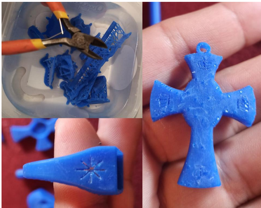
Слика 58. Одстрањивање потпорне конструкције након испирања и делимично брушење
