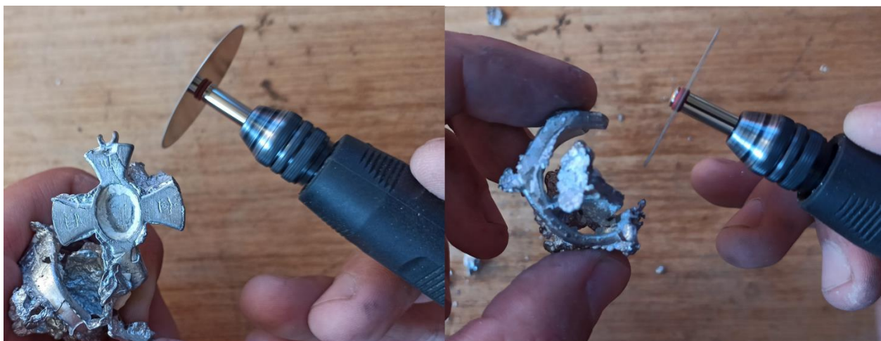
Слика 72. Одвајање одливака од јарбола и одстрањивање вишка материјала помоћу чеоне брусилнице са резном плочом
