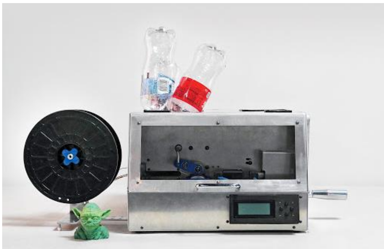
Слика 26. Графички приказ опреме за рециклажу/производњу материјала за 3Д штампу у кућним условима путем млевења и претапања коришћеног материјала [25]
