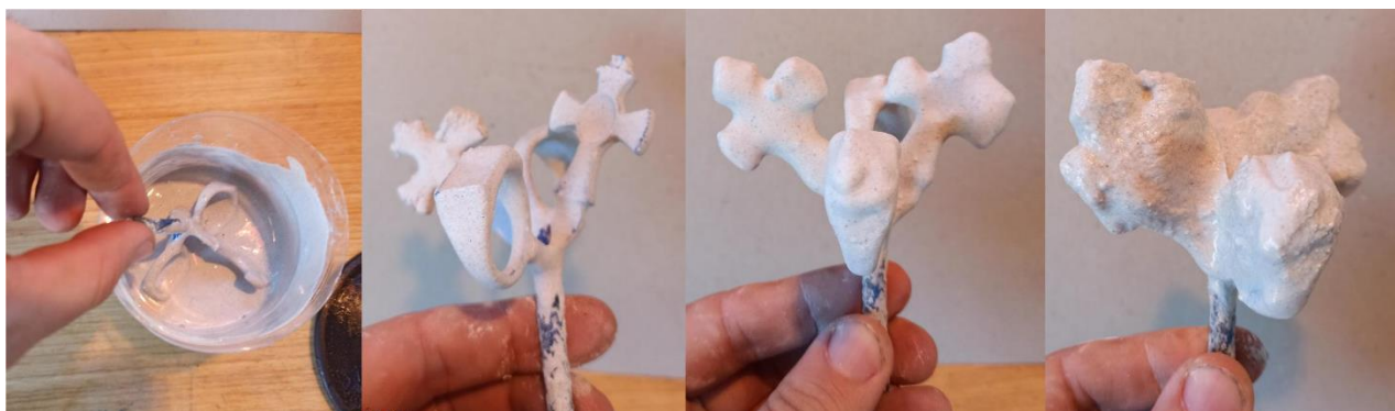
Слика 62. Сукцесивно наношење слојева гипса на модел утапањем у припремљени смешу
