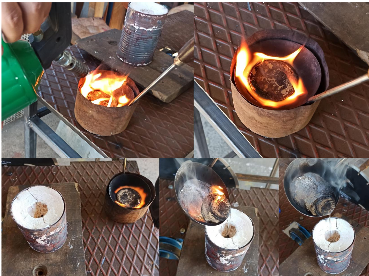
Слика 69. Кораци топљења калаја и уливања у калуп
