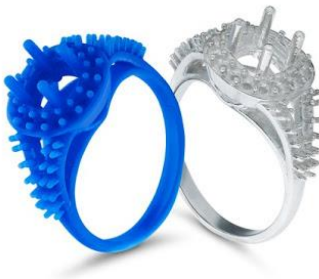
Слика 48. Графички приказ прстена произведеног помоћу 3Д штампе (лево) и прстена изливеног од метала у калуп који је израђен уз помоћ 3Д штампаног модела (десно) [53]
