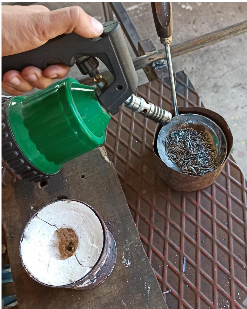
Слика 68. Припремљен калуп за уливање метала, посуда са дршком са уситњеним калајем и пропански бренер за топљење калаја
