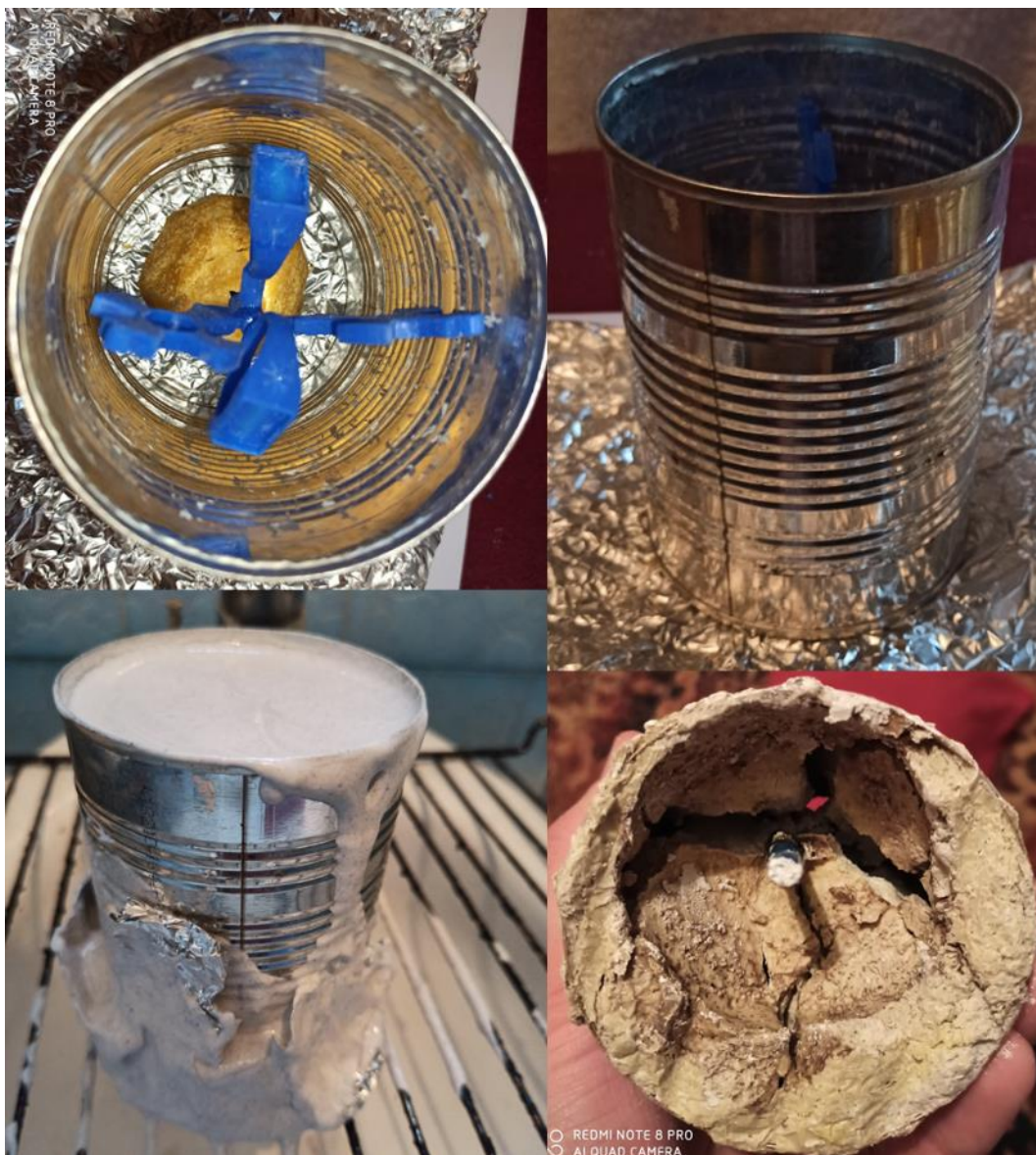
Слика 61. Постављање модела у цилиндар, заливање гипсом и приказ пукотина на калупу након процеса сушења у пећи
