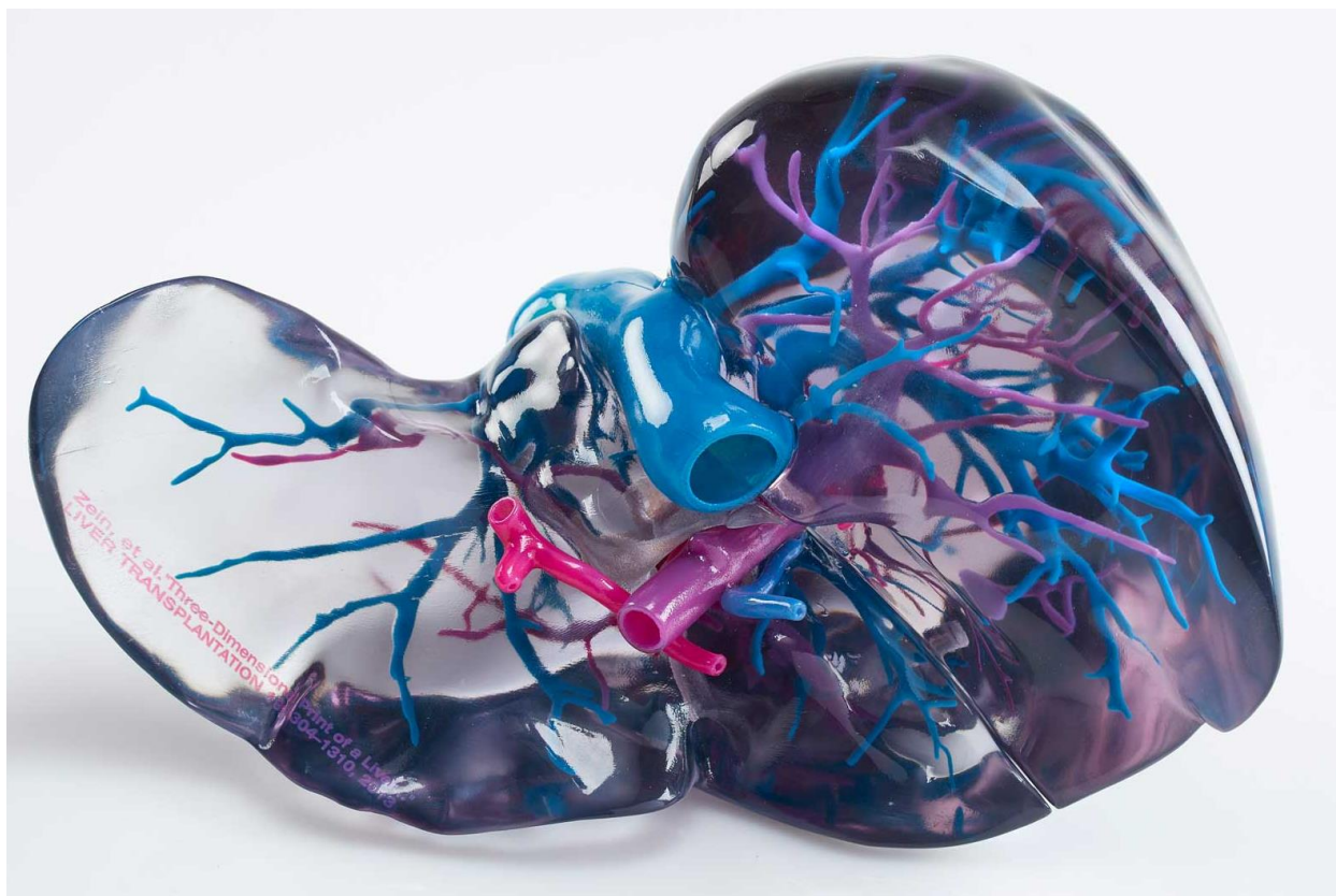
Слика 18. Пример штампе више различитих материјала у више различитих боја одједном, применом Material Jetting методе [17]
