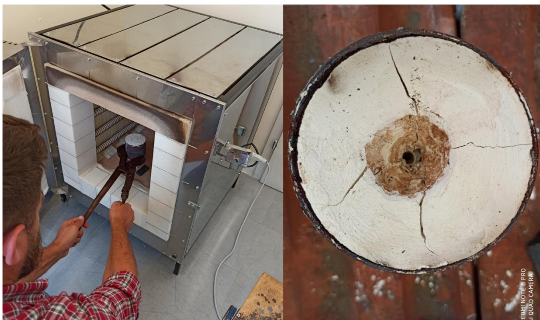
Слика 66. Вађење калупа из пећи (лево) и видне пукотине на калупу (десно)
