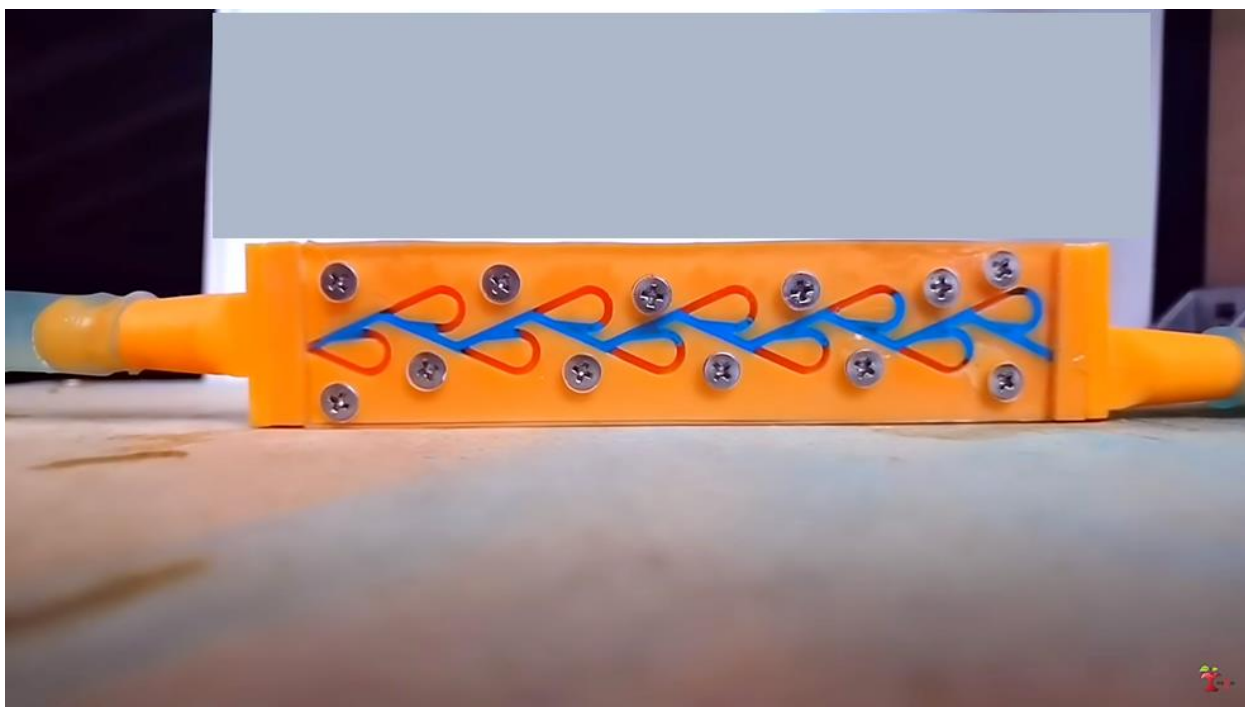
Слика 32. Графички приказ неповратног вентила у раду (са прозирном чеоном страницом) који је осмислио и патентирао Никола Тесла, израђен на 3Д штампачу (преузето са YouTube канала „Integza“) [31]
