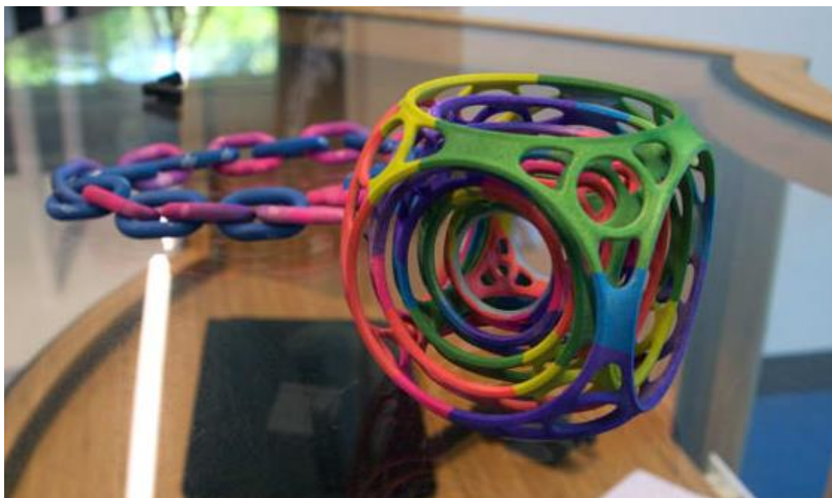
Слика 13. Модел штампан употребом више различитих боја са покретним елементима Binder Jetting методом[11]
