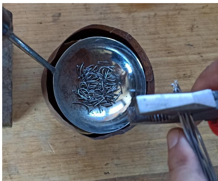
Слика 67. Уситњавање материјала зарад униформнијег и бржег топљења
