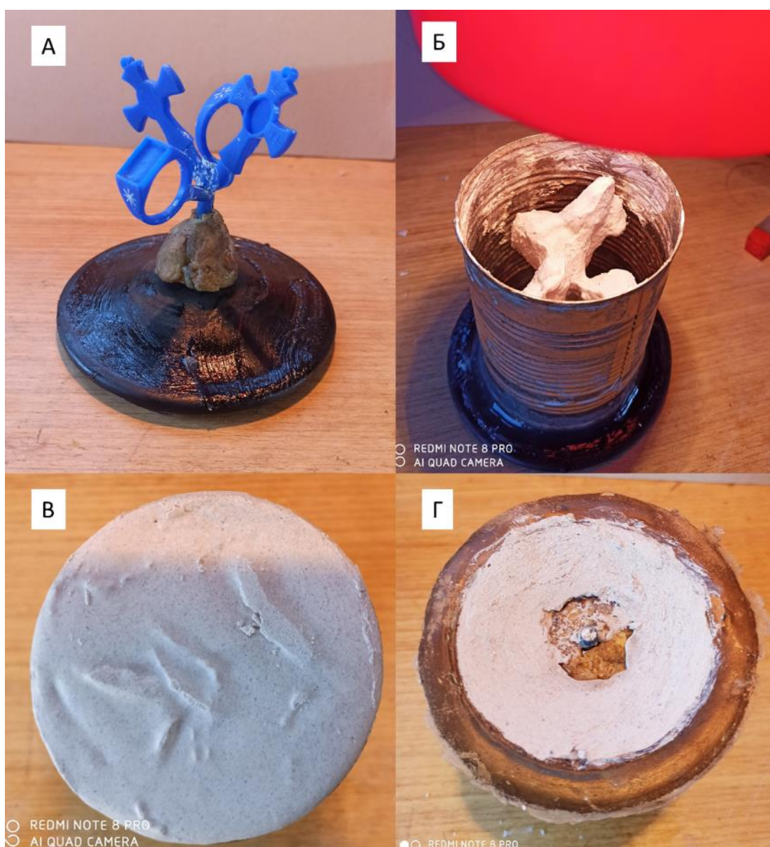
Слика 63. Модел на гуменом постољу са рупом у центру и додатком воска који треба формирати левак (А), сушење више слојева гипса на моделу испод лампе (Б), дно наливеног калупа (В), горња страна калупа наливеног гипсом (Г)
