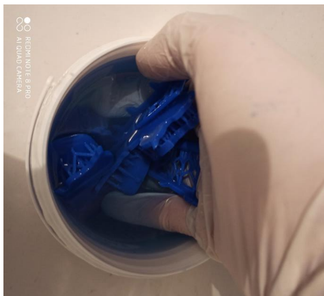
Слика 57. Испирање штампаних модела у изопропил алкохолу
