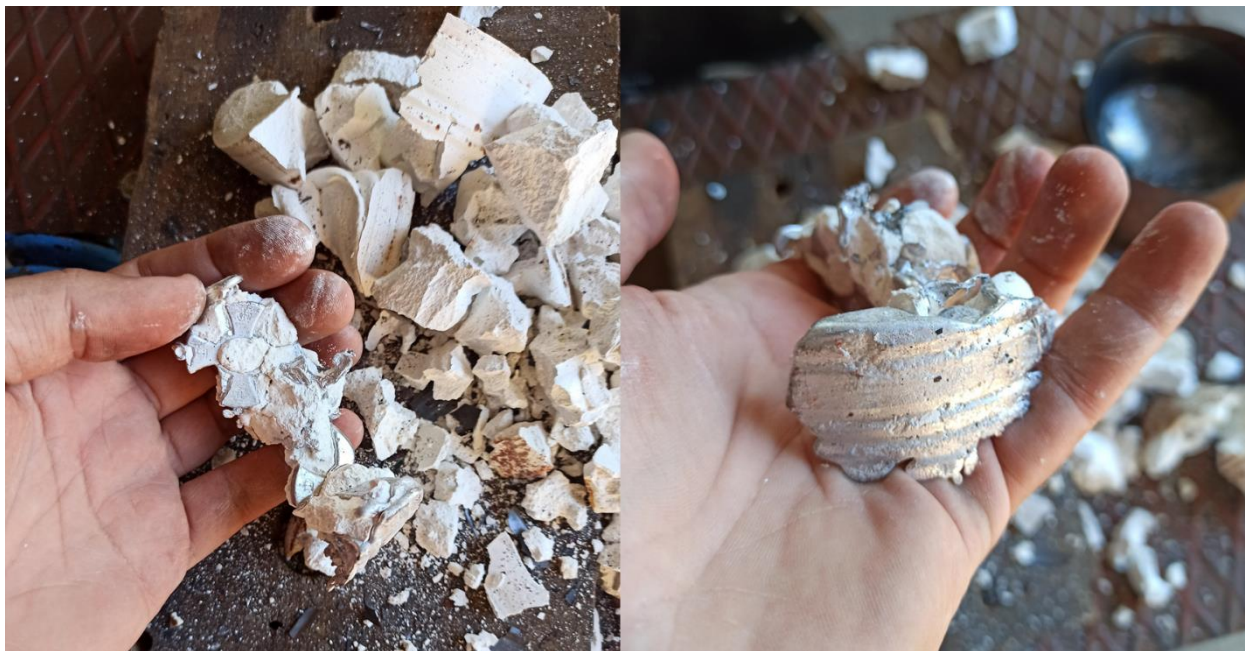
Слика 71. Одвајање одливака од калупа (лево) и метал који је исцурео из шупљине модела у пукотине калупа, око 30% укупне масе метала (десно)
