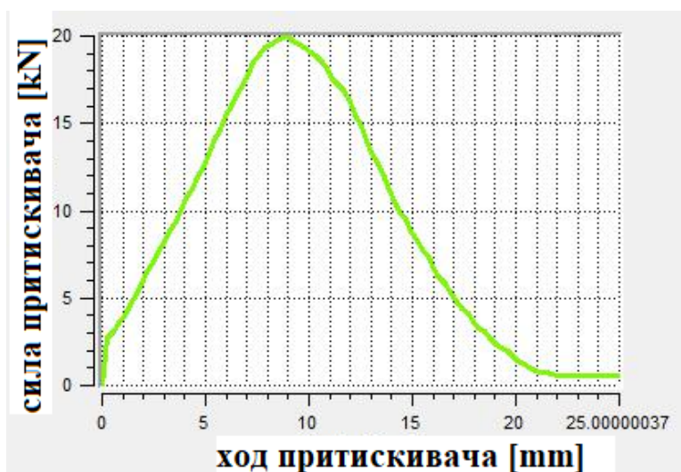
Сл. 5.63 Дијаграм деформационе силе у HE-1-50-24 ( d_{gr} = 50 \text{ mm} ; d_o = 24 \text{ mm} ; s = 1 \text{ mm} )
