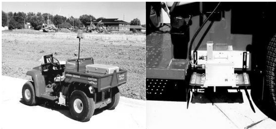
Слика 23. Профиломер “ LISA ”: лево - возило, десно - детаљ бесконтактнoг давача [6]
