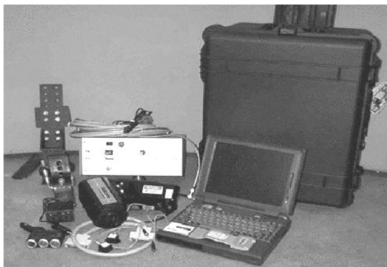
Слика 26. “ROSAN” преносни ласерски профиломер [6]
