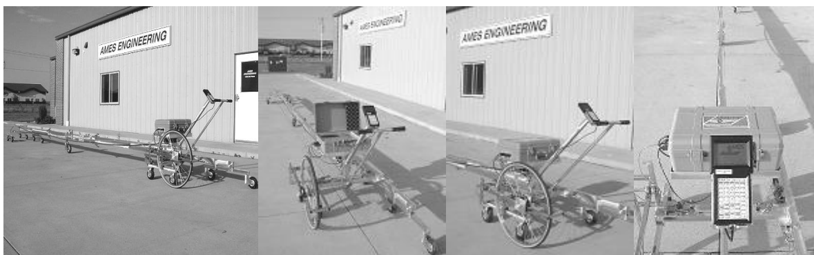
Слика 18. Компјутеризовани профилограф фирме “AMES Engineering”, модел 4200 [6]
