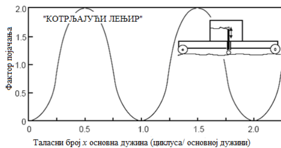
Слика 4. Одзив мерног уређаја за мерење неравнина типа „котрљајућег лењира“ [6]
