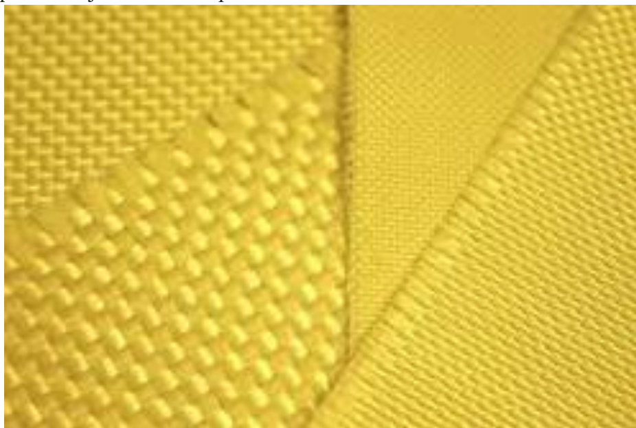
Слика 6. Различите тканине од арамидних влакана (Go Green Products)
