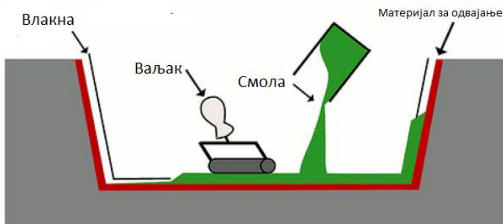
Слика 22. Поступак ручног слагања (Fibre Reinforced Plastic, 2009)
