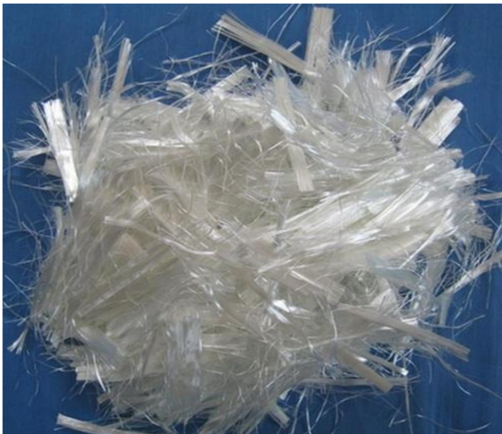
Слика 5. Стаклена влакна у форми кратких вискера (Geosconproducts)
