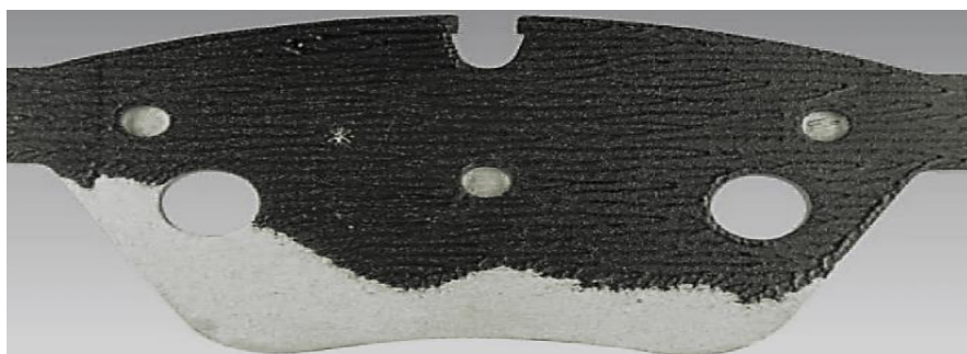
Слика 2.18 Изглед структуре носача плочице [6]
