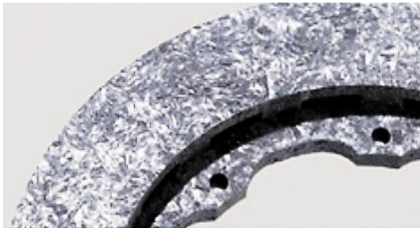
Слика 2.15 Приказ кочионог диска израђен од C-SiC [7]
