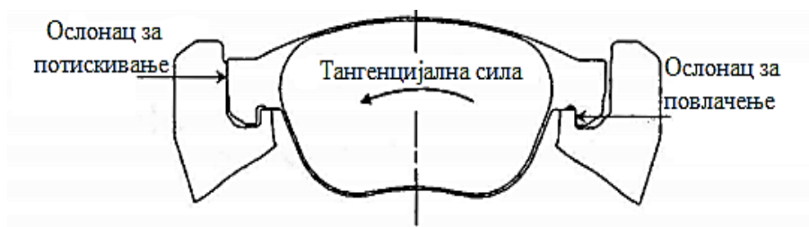
Слика 3.3 Деловање тангенцијалне силе код кочионих плочица [12]
