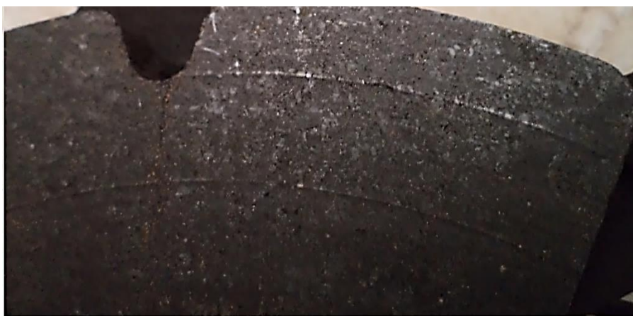
Слика 2.17 Структура облоге кочионих плочица [6]
