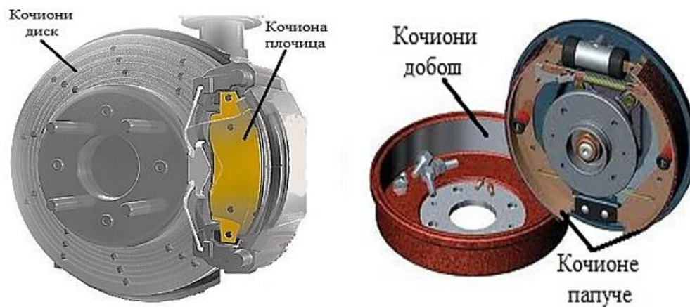
Слика 3.8 Трибомеханички систем кочионих елемената [15]
