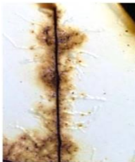
Слика 3.14 Пример корозије у зазорима [6]
