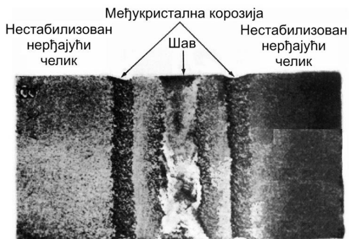
Слика 3.10 Међукристална корозија завареног споја од нестабилизованог нерђајућег челика [1]
