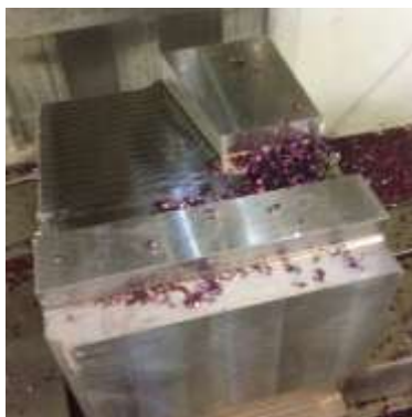
Слика 6.16. Машинска обрада комада у четвртом стезању, без емулзије за хлађење
