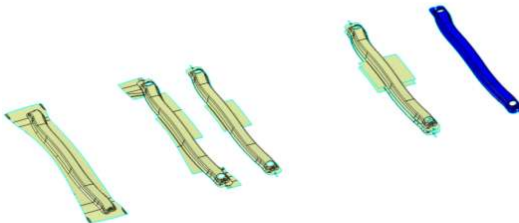
Слика 2.13. Метода за добијање готовог комада у трансфер алату
