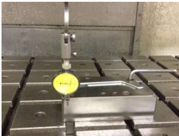
Слика 4.5. Одређивање полаза за машинску обраду комада уз помоћ 3D тастера
