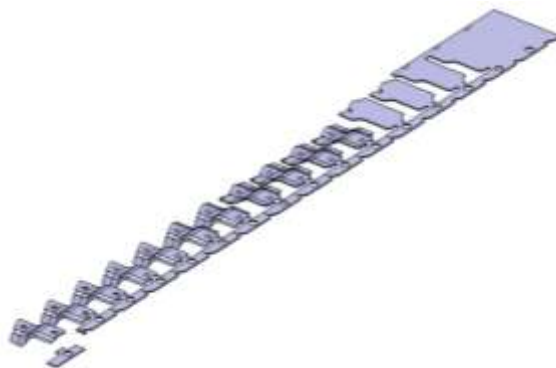
Слика 2.1. Метода за добијање готовог производа у корачном алату
