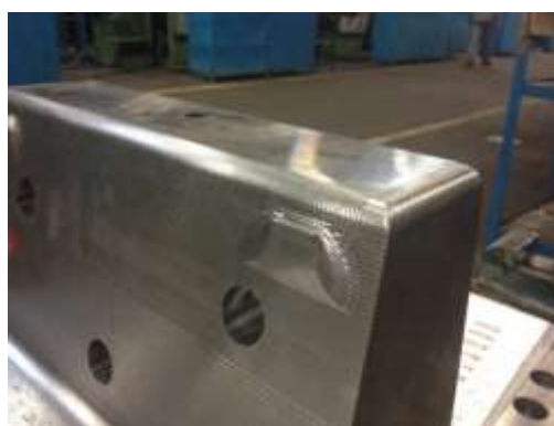
Слика 6.20. Додатак за ослањање комада после термичке обраде
