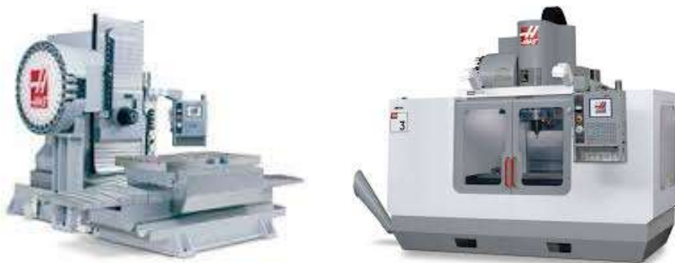
Слика 3.9. Хоризонтална и вертикална CNC глодалица [2] [3]
