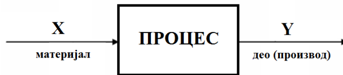
Слика бр. 4: Производна операција као процес трансформације материјала
