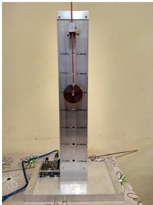
Слика 7.1.3.1 Физичко клатно у мировању, на растојању 150 mm од тачке вешања
