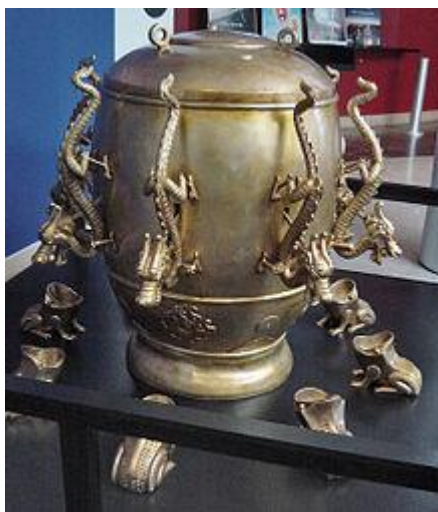
Слика 3.1. Реплика Зханг Хенговог клатна (5)
