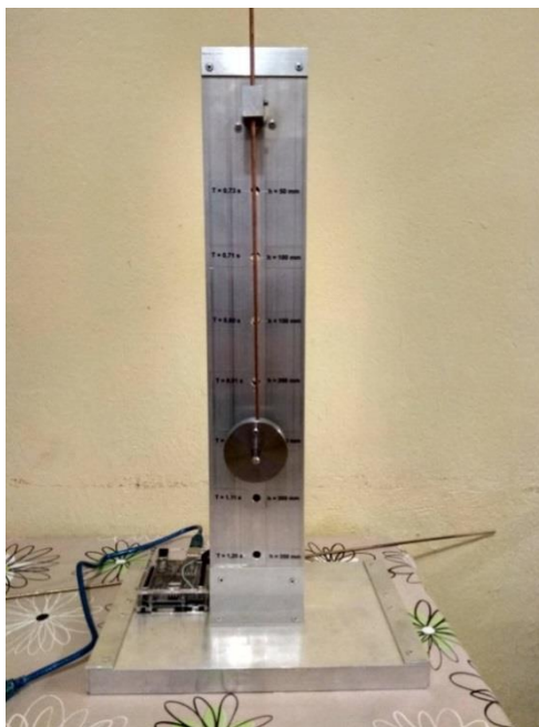
Слика 7.1.5.1. Физичко клатно у мировању, на растојању 250 mm од тачке вешања
