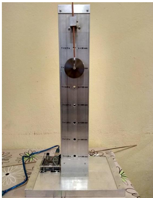
Слика 7.1.2.1. Физичко клатно у мировању, на растојању 100 mm од тачке вешања
