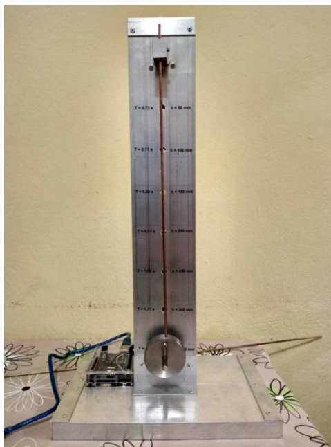
Слика 7.1.7.1. Физичко клатно у мировању, на растојању 350 mm од тачке вешања
