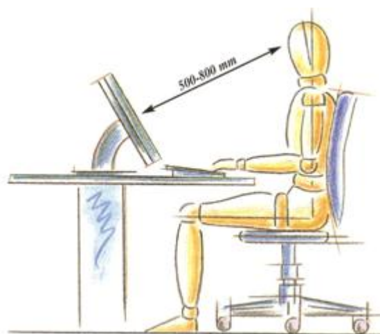
Слика 22. Препоручљива видна удаљеност [9]
