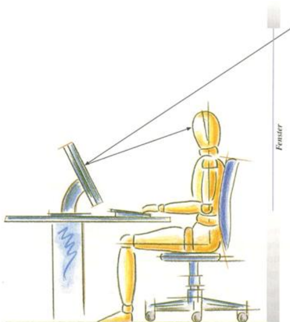
Слика 26. Заслепљивања због превеликих разлика у осветљености у видном пољу (Прозор)[9]
