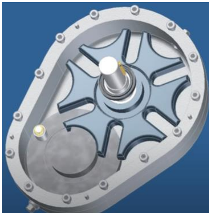
Слика 1.3 Савремени механизам на принципу Малтешког крста [3]
