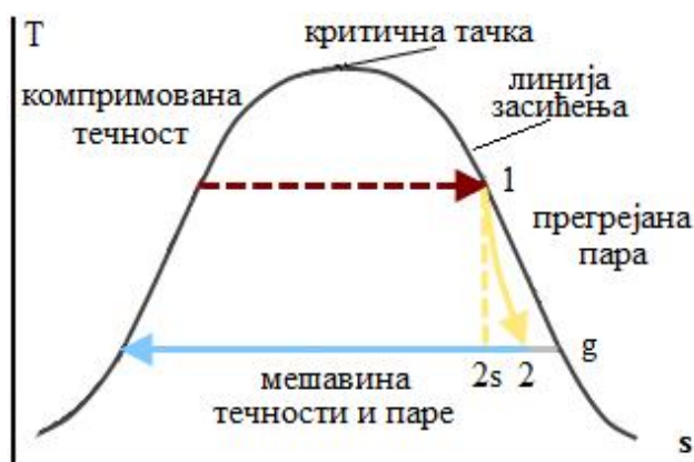
Слика 15: T - s дијаграм електрана са сувом паром
