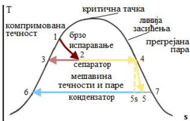
Слика 17: T - s дијаграм „single flash steam“ циклуса
