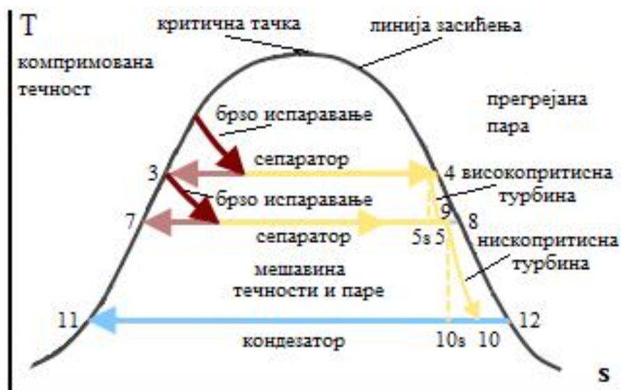
Слика 19: T - s дијаграм двостепеног циклуса у постројењима са две турбине
