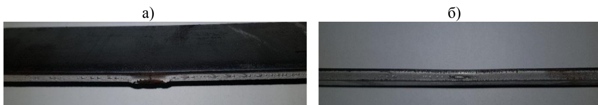
Слика 61 – Приказ лошег (а) и доброг (б) реза ножа
