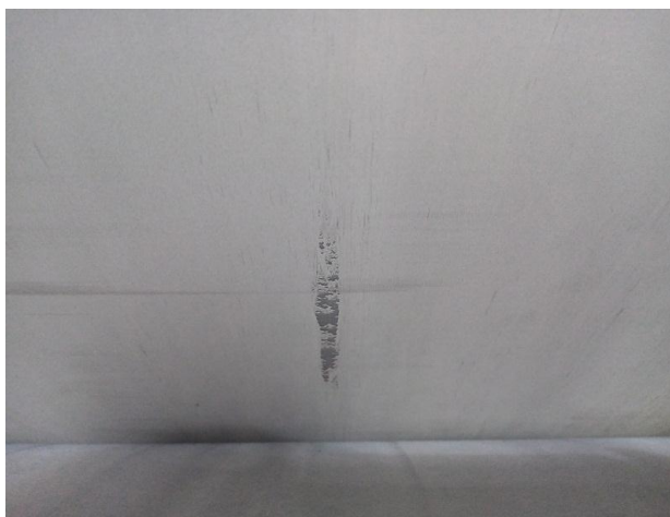
Слика 57 – Уваљана коварина са доње стране траке
