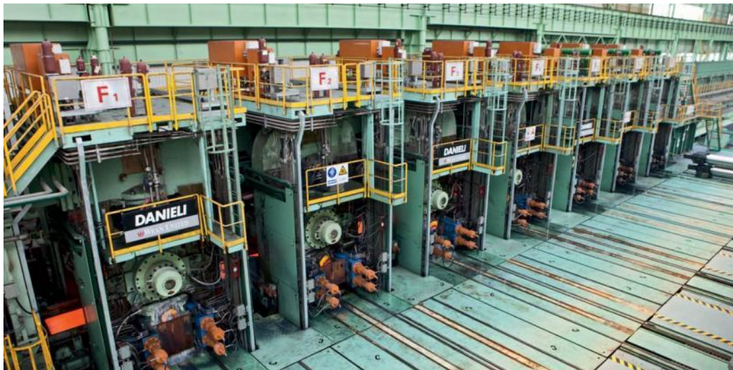
Слика 37 – Изглед седмостанске линије завршног ваљања
