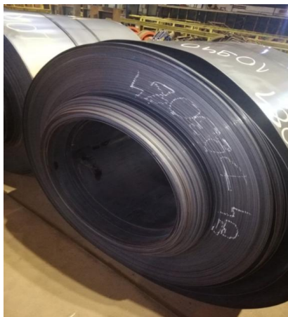
Слика 54 – Телескопија на делу траке
