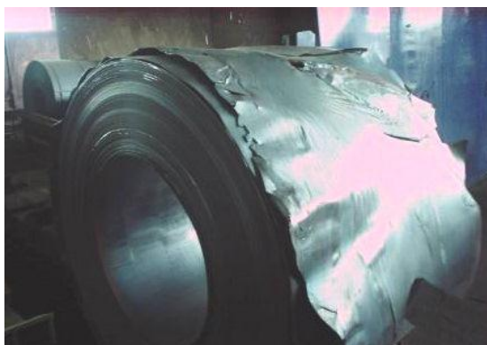
Слика 52 – Цепање задњег краја траке
