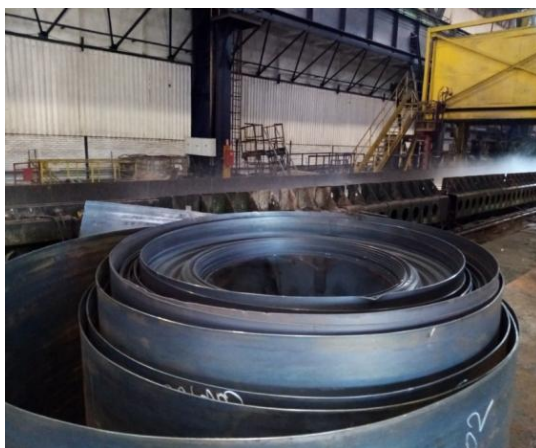
Слика 51 – Гужвање котура на завршној прузи
