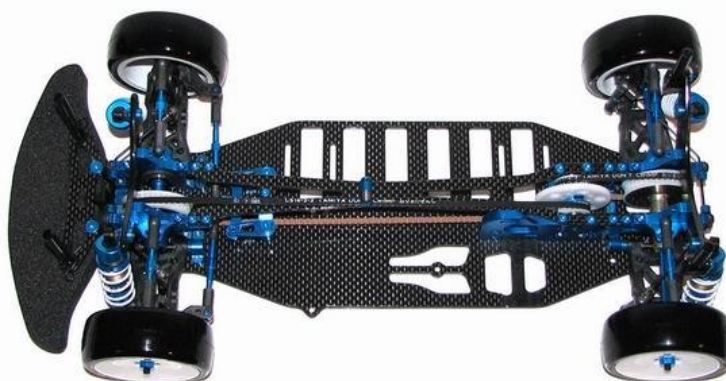
Слика 1.4. Носећа конструкција.[14]
