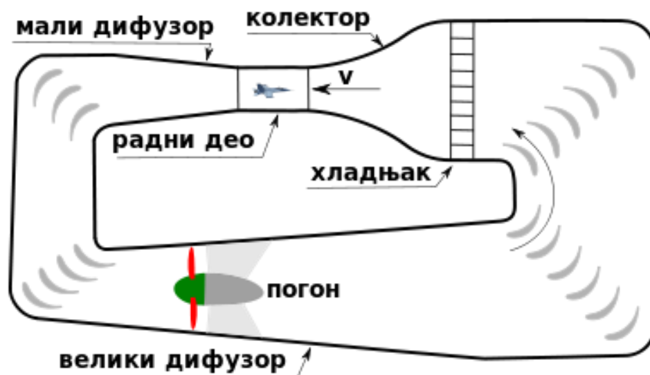
Слика 4.2 Шема аеротунела повратне ваздушне струје.[13]
