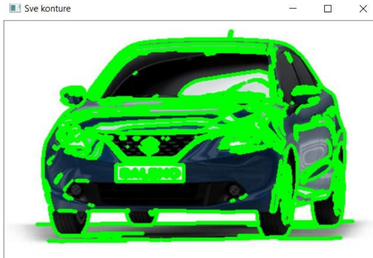
Слика 24. Приказ детектованих контура возила
