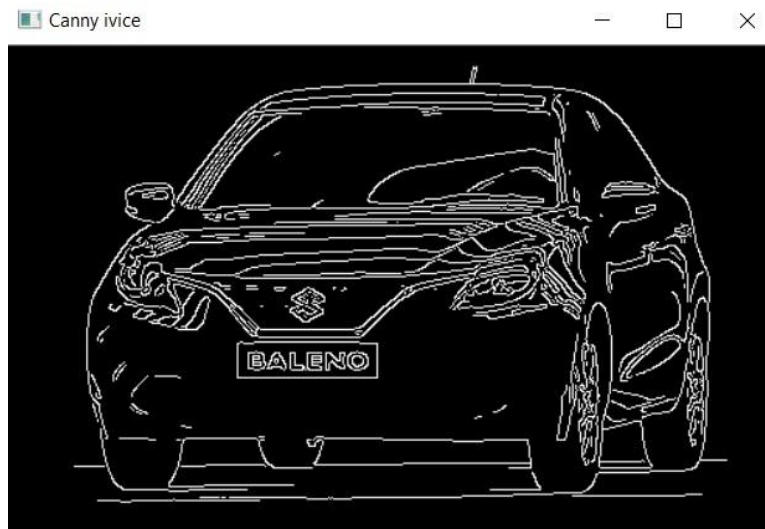
Слика 23. Приказ canny ивица возила
