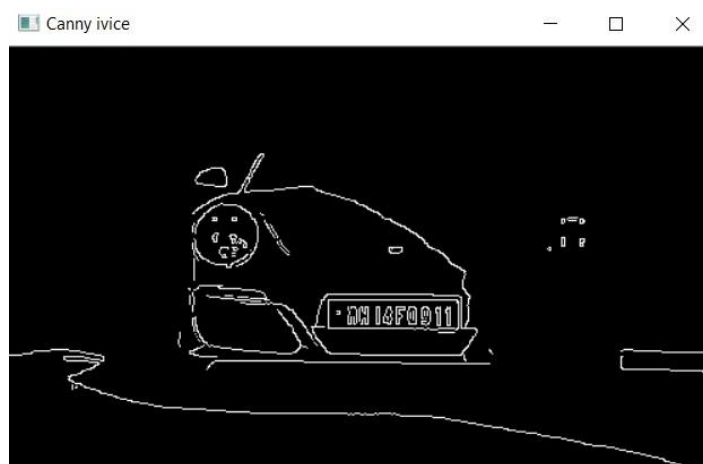
Слика 36. Приказ canny ивица возила
