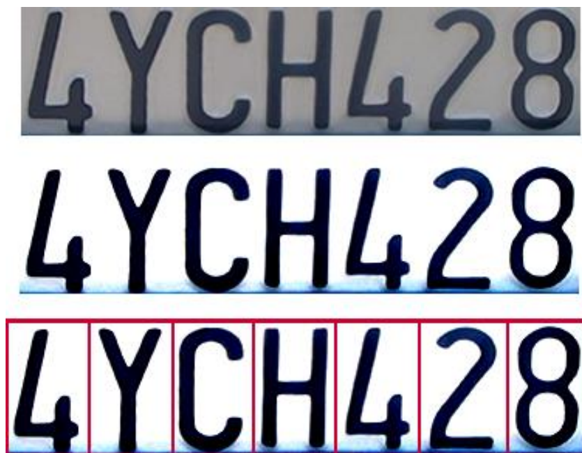
Слика 4. Кораци 2, 3 и 4: регистарска таблица је нормализована за осветљеност и контраст, а затим се карактери сегментирају како би били спремни за OCR [16]
