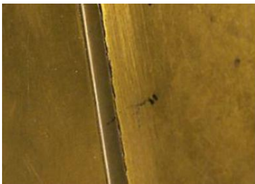
Слика 5.1 Спајање истих материјала FSW поступком – месинг [18]
