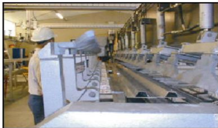
Слика 6.1 Спајање монтажних, алуминијумских плоча поступком FSW, у производњи бродова [1]
