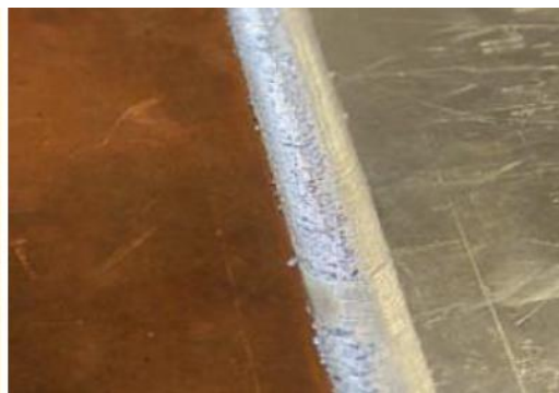
Слика 5.2 Спајање различитих материјала FSW поступком – бакар и алуминијум [18]
