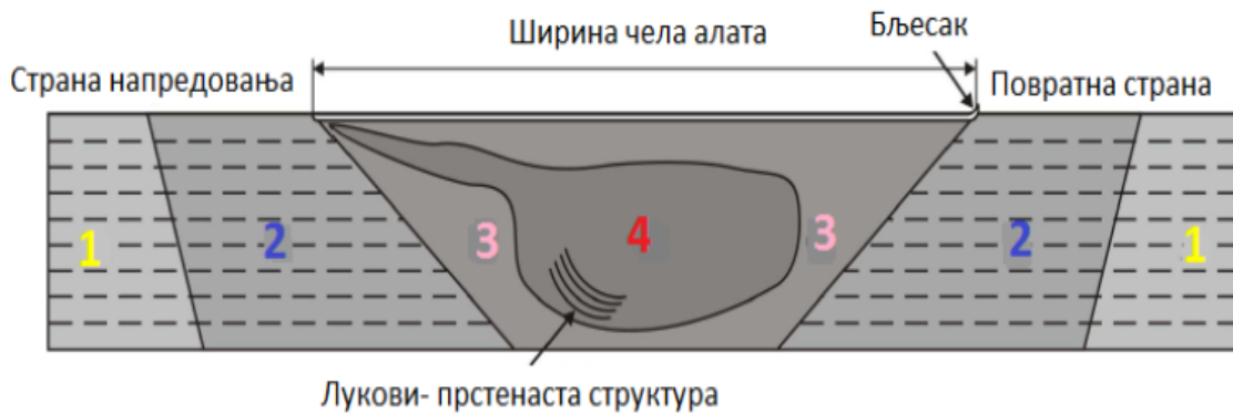
Слика 3.7 Структура завареног споја поступком FSW [9]
