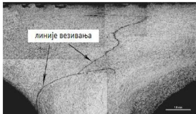
Слика 3.13 Простирање грешке типа линије везивања у Т-споју [19]
