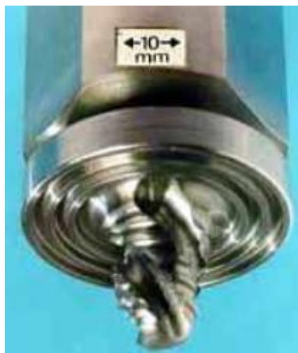
Слика 4.13 Мулти спирални алат за FSW [1]
