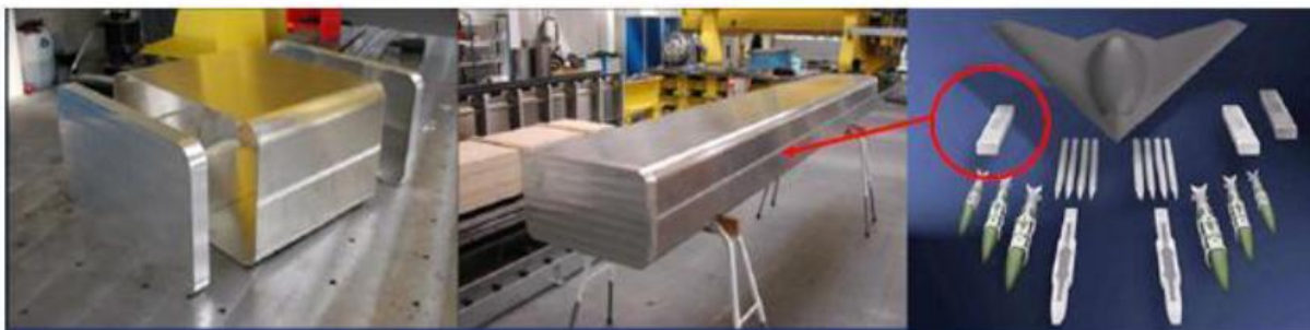
Слика 6.6 Употреба FSW при изради резервоара за беспилотне летелице [4]
