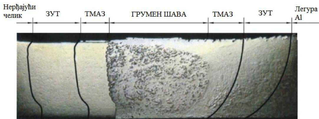
Слика 5.4 Макроскопски изглед пресека FSW споја легуре Al 6013-T4 и нерђајућег челика X5CrNi18-10 [18]
