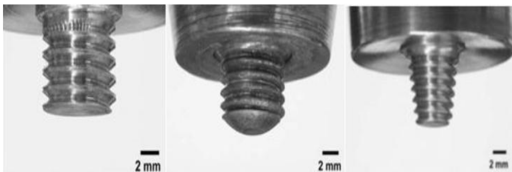
Слика 4.11 Врх трна алата: а) цилиндрични трн са равним врхом , б) цилиндрични трн са куполом на врху и в) трн конусног облика са равним врхом [11]
