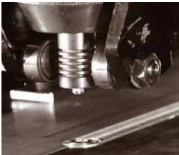
Слика 4.5 Систем за контролу дубине продирања чела алата у материјал који се састоји од два помоћна ваљка [1]
