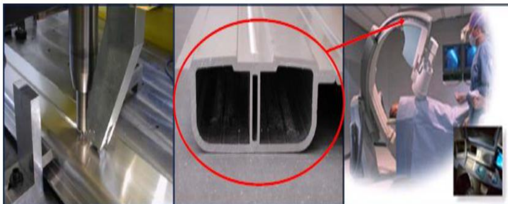
Слика 6.8 Делови за скенер направљени FSW поступком [6]
