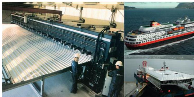
Слика 7. ESAB SuperStir у бродоградилишту „ Marine Aluminium “, велики бродови као типични примери на којима се заварују панели поступком FSW [19]
