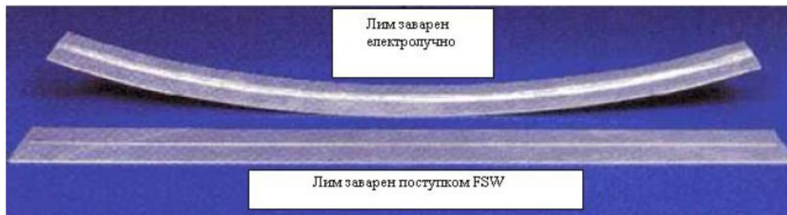
Слика 3.19 Лимови заварени електролучно и поступком FSW [8]
