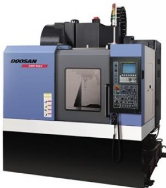
Слика 3.3 CNC глодалица DOOSAN, која се користи у фабрици Застава Оружје
