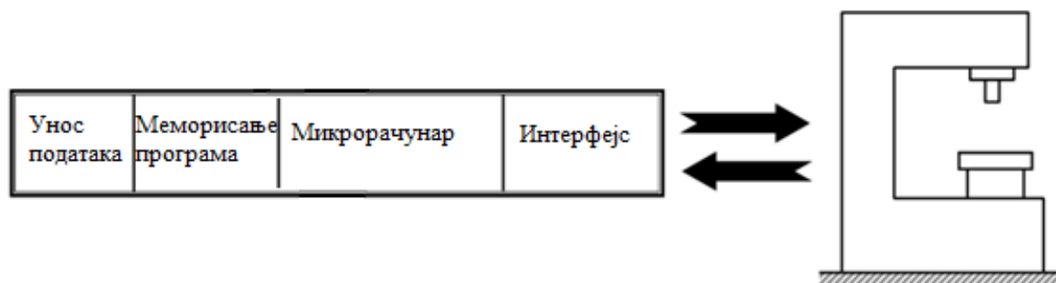
Слика 2.2 Општа конфигурација компјутерски управљаног обрадног система[1]
