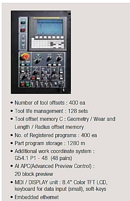
Слика 3.6 Управљачка табла глодалице DOOSAN
