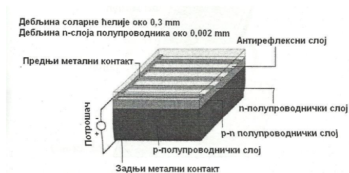
Слика 6. Принцип функционисања фотонапонске ћелије
